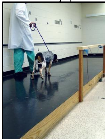
Figura 21 - Plataforma de força para análise de marcha.
