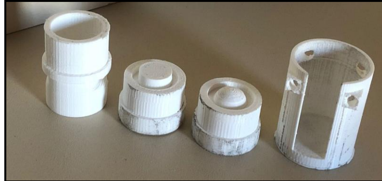
Figura 51 – Partes impressas da prótese.
