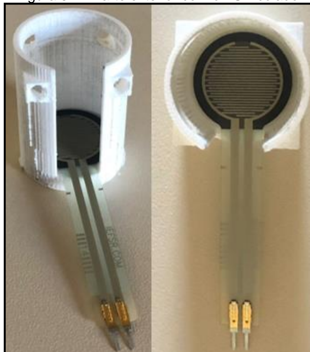
Figura 54 – Parte exterior com o FSR colado.
