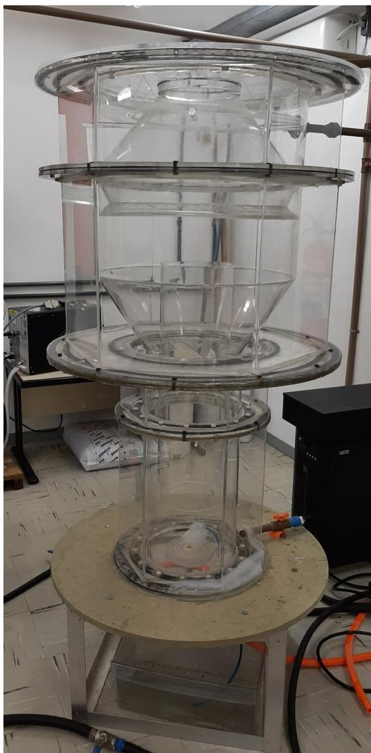
Figura 4: Reator *Gaslift* utilizado. Fonte: O Autor.
