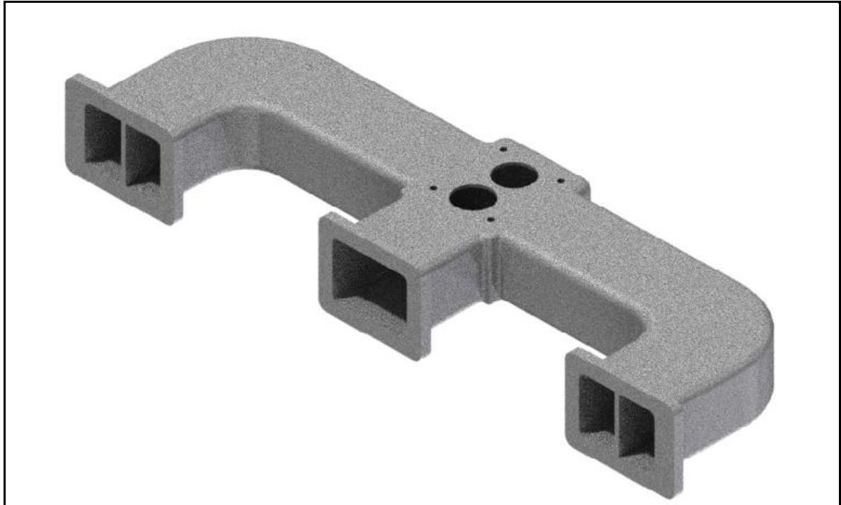
Figura 8 – Coletor de admissão modelado em CAD
