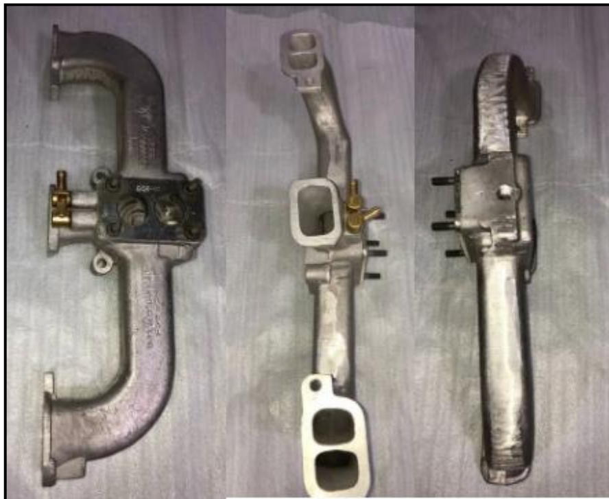
Figura 5 – Coletor de admissão original do motor Chevrolet 4100
