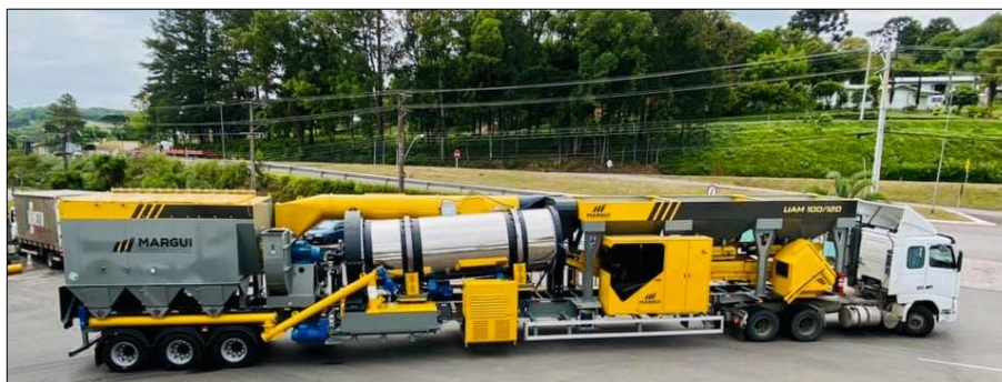
Figura 6 - Transporte de Usina Móvel
