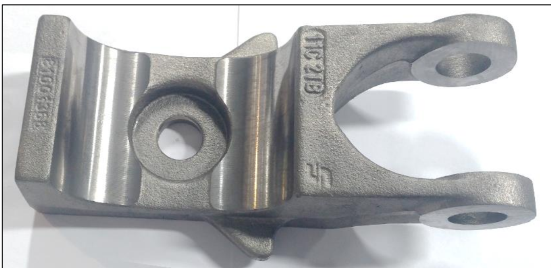
Figura 1 – Suporte fundido código 1368, usinado na CSF
