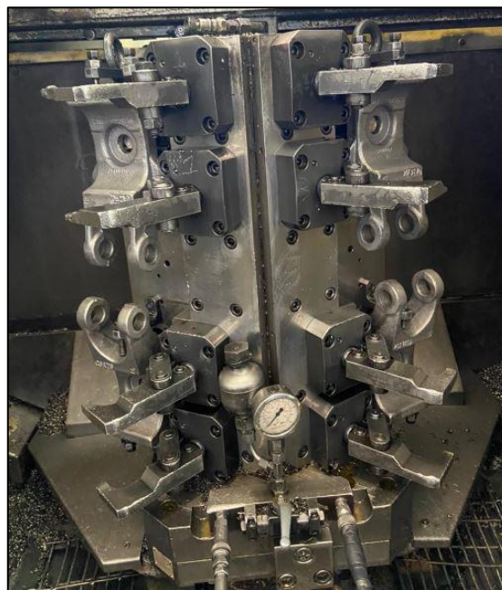
Figura 17 – Dispositivo hidráulico para fixação dos suportes na usinagem
