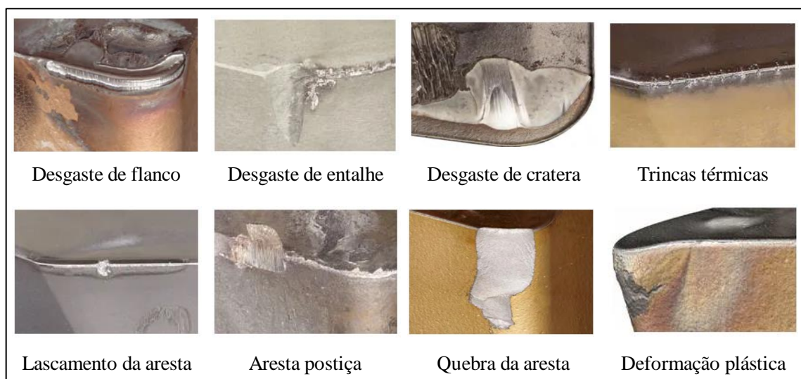
Figura 11 – Tipos de desgaste das ferramentas de corte
