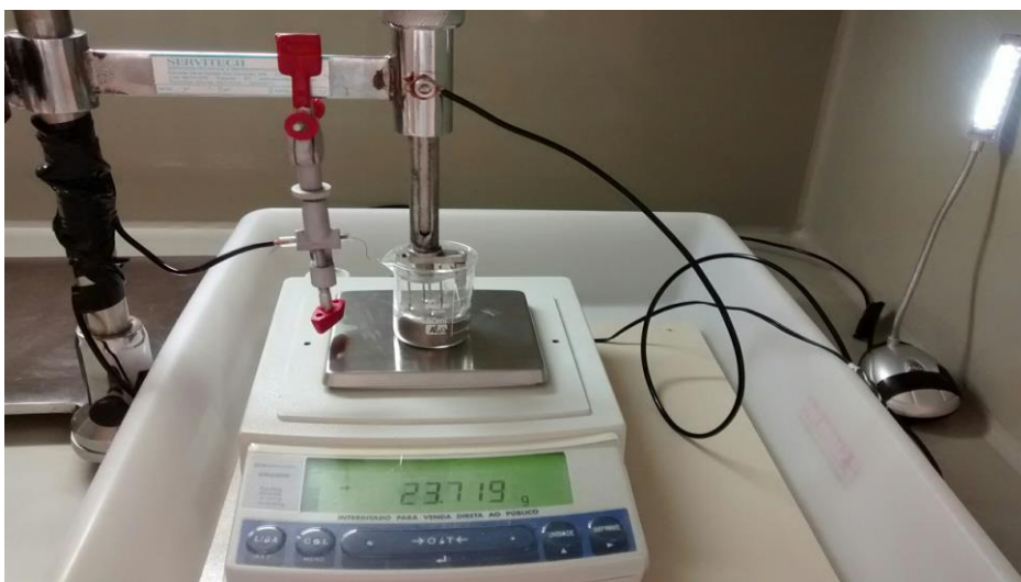
Figura 15 – Suporte para a medição de densidade por imersão em mercúrio.
