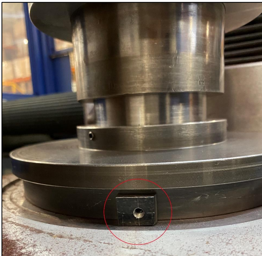
Figura 19 - Ponto de fixação do sensor no eixo árvore
