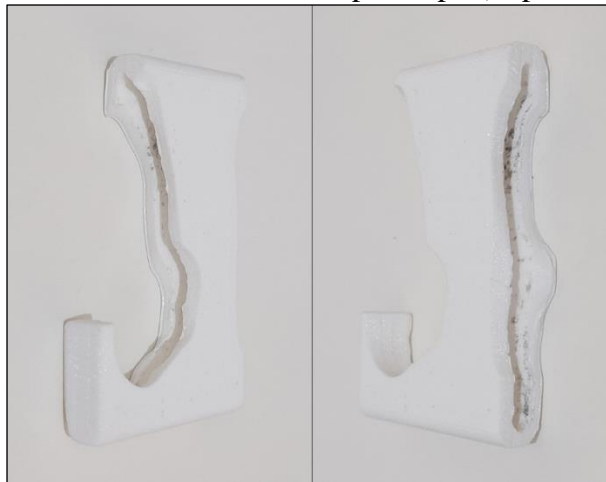
Figura 31 - Gabarito em versão protótipo (impressão 3D)
