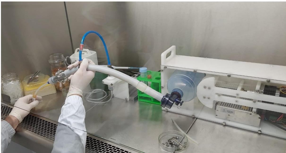
Figura 24 - Montagem do dispositivo simulador de respiração e partes necessárias na cabine de segurança FILTERFLUX, modelo SBIIIB2 - 1266/4.
