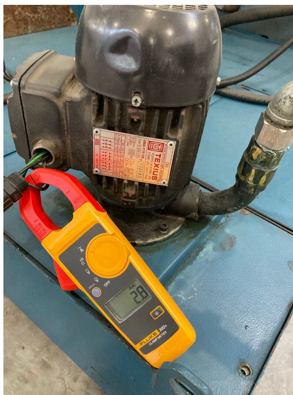
Figura 9 – Alicate Amperímetro Medindo o Motor M3
