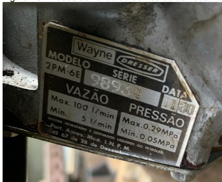
Figura 16 - Dados de vazão da bomba de combustível
