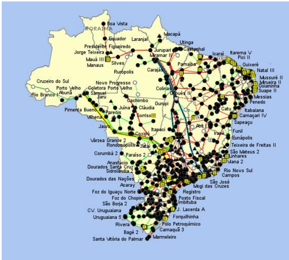
Figura 5 – Sistema interligado nacional - rede de operação – horizonte 2023
