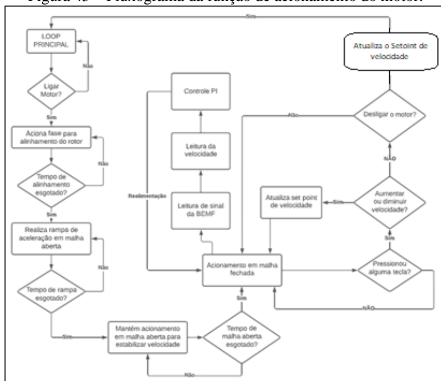
Figura 45 – Fluxograma da função de acionamento do motor.
