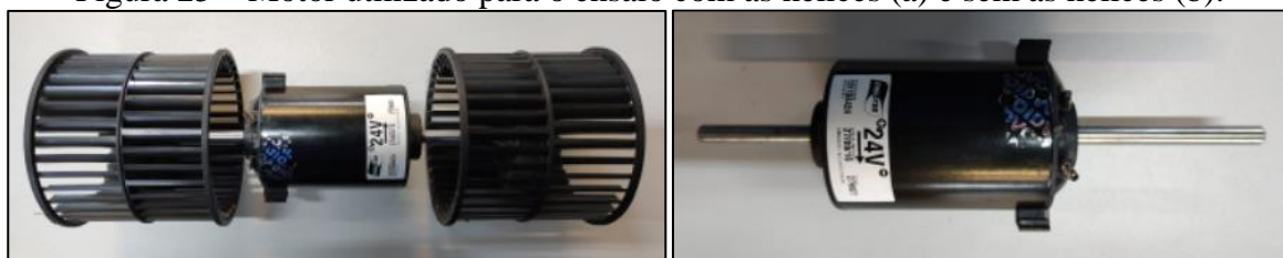
Figura 25 – Motor utilizado para o ensaio com as hélices (a) e sem as hélices (b).
