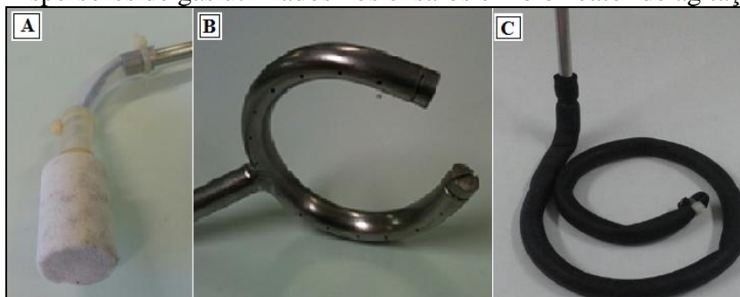
(A) aerador tipo pedra sinterizada; (B) ferradura de aço inoxidável; (C) aerador de aquário
