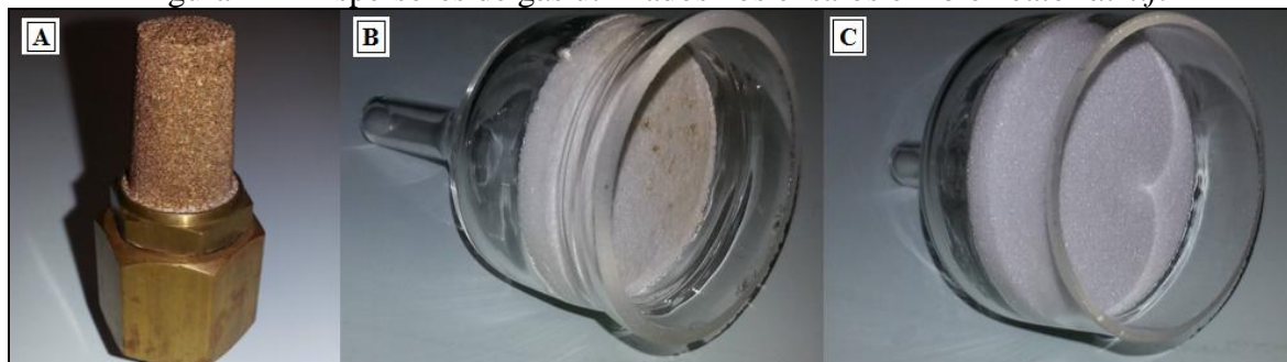
(A) aerador de latão, (B) funil sinterizado \phi = 4cm, (C) funil sinterizado \phi = 5cm
