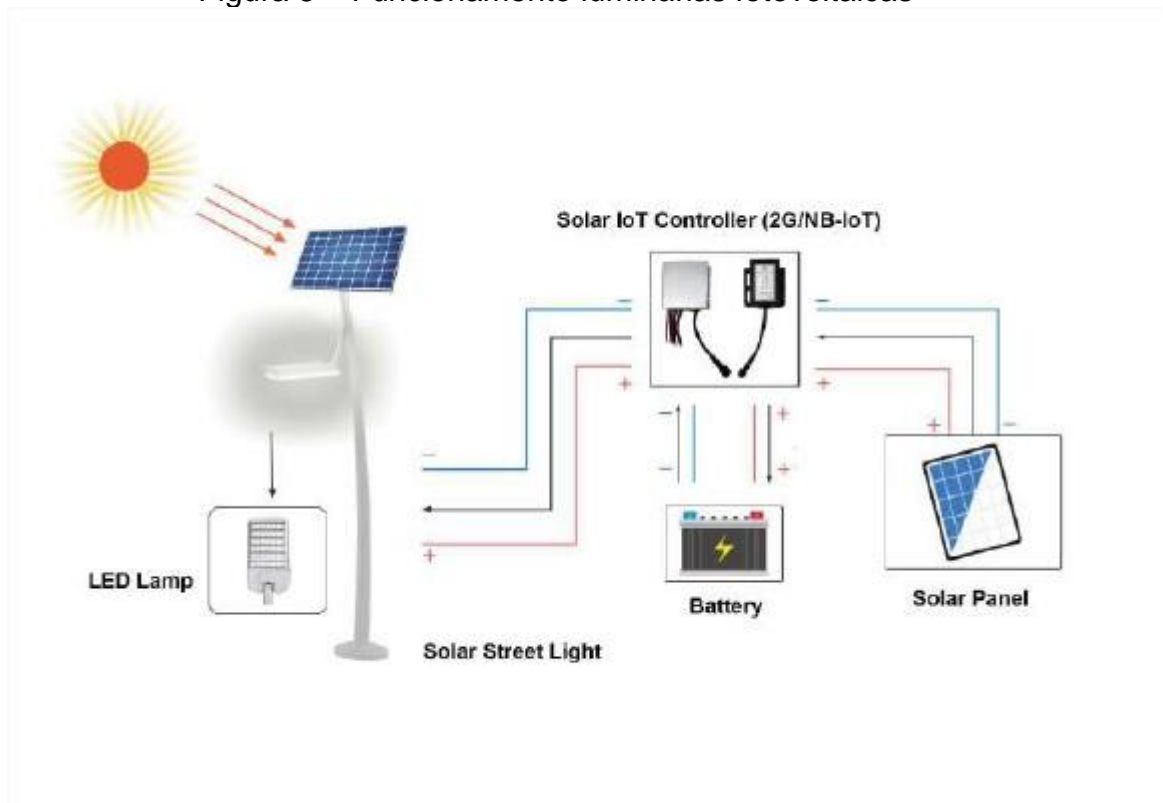
Figura 5 – Funcionamento luminárias fotovoltaicas
