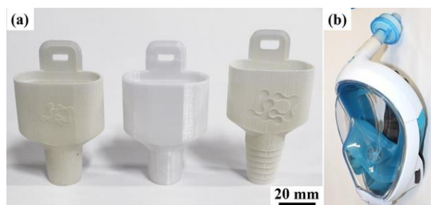
Figura 2 - Modelos de válvulas impressas em 3D para adaptação à máscaras de mergulho
