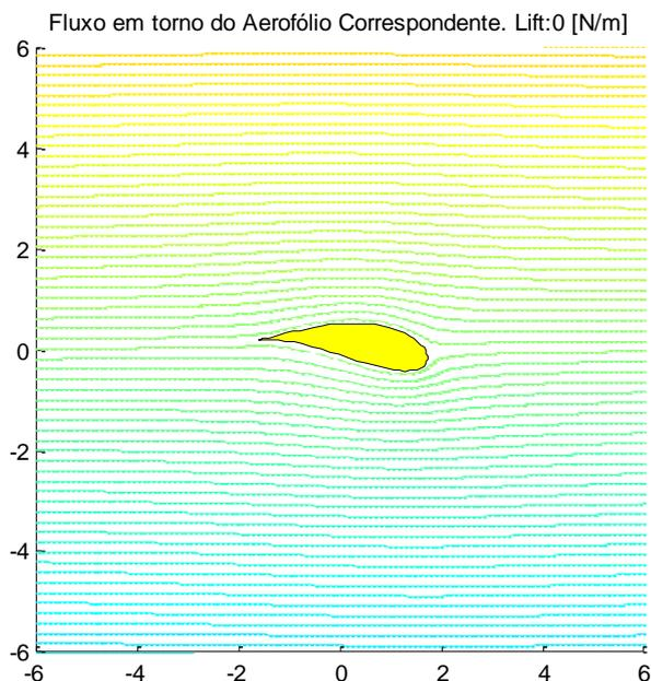
Mas, somente ter um perfil de asa não é suficiente para o avião ganhar sustentação; nas figuras acima, todas possuem um título: “Fluxo em torno do Aerofólio Correspondente. Lift: 0 [N/m]” que é o valor da força de sustentação, assim, percebemos que o aerofólio não gera sustentação. Assim, alterando alguns dados iniciais é possível perceber que a força de sustentação será alterada.
