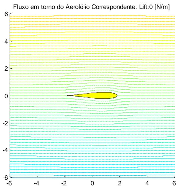
A figura acima foi gerada, através de um círculo com centro em  $(0.1, 0)$ . Percebemos que o perfil de asa ganhou forma, tem espessura, mas não apresenta curvatura, conhecido também com um perfil simétrico. Deslocando o círculo mais da origem, o perfil de asa será mais espesso.
