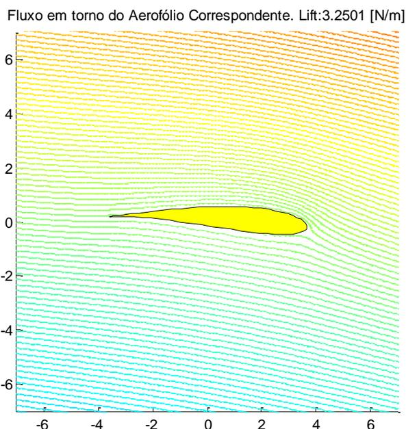
Para gerar o perfil acima foram utilizados os mesmos dados do último perfil, porém, o raio foi alterado de 1 para 2, assim, a corda aumentou, tendo um tamanho próximo ou igual a 8 unidades de comprimento.
