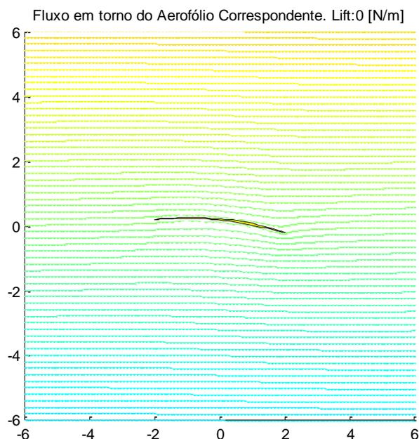
Alterando somente o eixo  $y$ , no círculo com centro em  $(0, 0.1)$ , a linha reta sofreu alteração, ficando uma curva e com uma espessura pequena. Assim, ao alterar o eixo  $y$ , a transformação altera significativamente a curvatura e altera um pouco a espessura do perfil.
