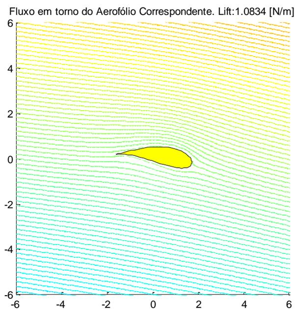
A figura acima representa o perfil de asa criado anteriormente, mas alteramos o ângulo assintótico da velocidade, ao invés de 0 utilizamos 10. O ângulo assintótico da velocidade é a inclinação do fluxo de vento em relação ao horizonte. Alterar o módulo assintótico da velocidade para mais, fará, também, que a força de sustentação aumente, como ilustra a figura abaixo, onde foi alterado o valor do módulo assintótico da velocidade, de 16 para 24.
