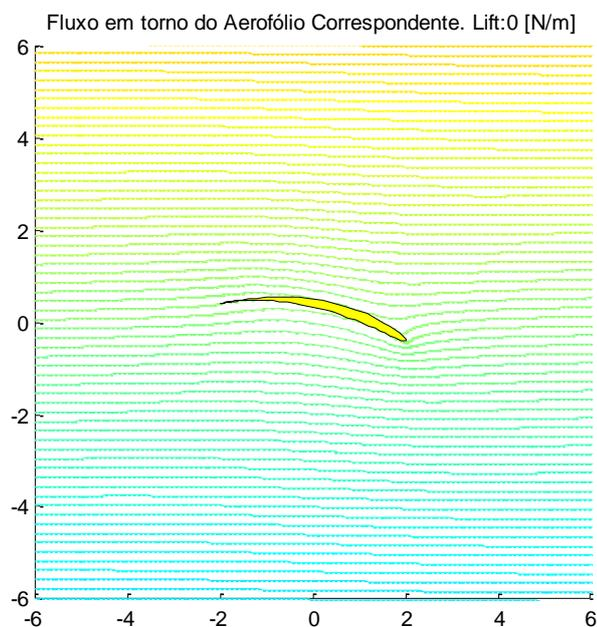
A figura acima foi gerada através de um círculo com centro em  $(0, 0.2)$ . Percebemos que a curvatura aumentou, como também a espessura do perfil, mas não basta alterar somente um dos eixos do centro do círculo, é necessário alterar os dois eixos. Veja a figura abaixo, um
