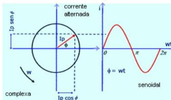
A corrente  $I$ , num circuito alimentado por uma dessas fontes, também pode ser representada da mesma forma por um vetor girante:  $I = I_p \text{ sen } \omega t$  (ou  $\cos \omega t$ ) ou  $I = I_p e^{i\omega t}$ .
