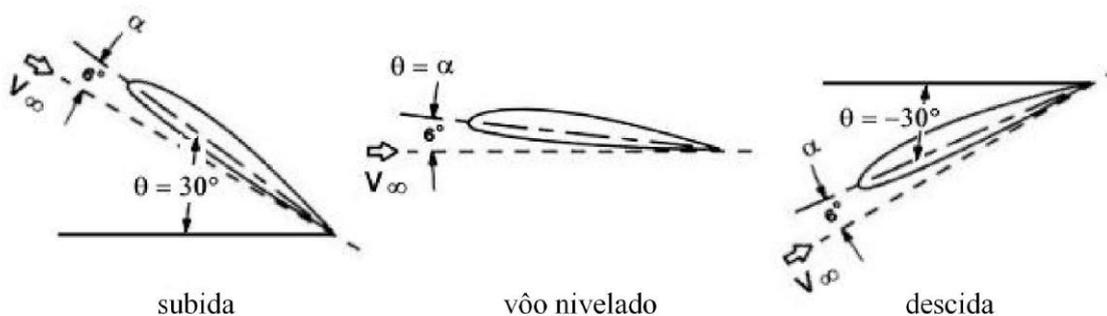
A sustentação é a componente da força perpendicular ao vento relativo, enquanto arrasto é a componente paralela a ele. Geralmente, os vetores de sustentação e arrasto são desenhados perpendicular e paralelamente à corda do aerofólio, o que não é muito correto (EASTLAKE, 2002).
