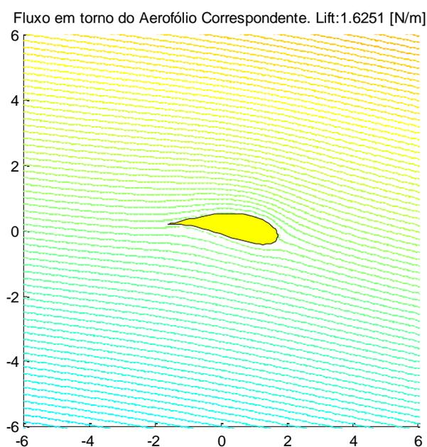
O raio do círculo influência para determinar o tamanho da corda do perfil de asa, e a relação é de 1 para 4, ou seja, se o raio do círculo for de uma unidade de comprimento, o tamanho da corda será de 4 unidades de comprimento, como pode ser observado nos perfis criados acima.
