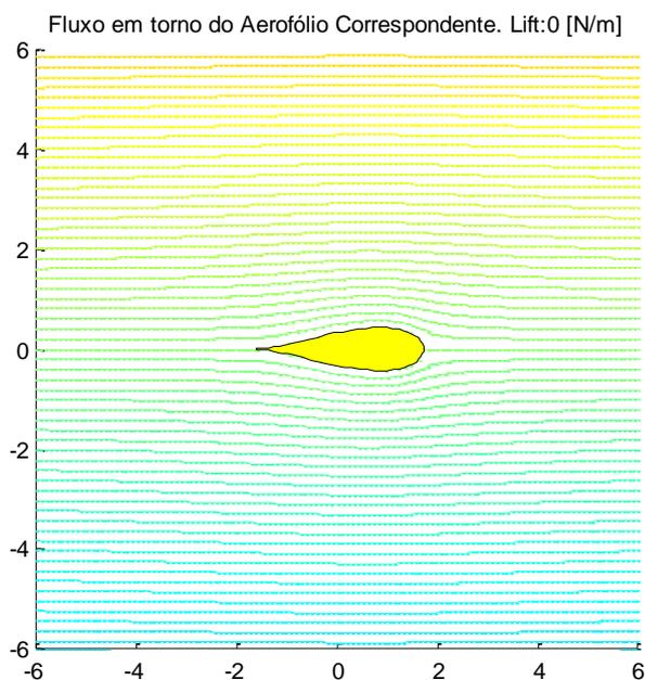
Este é um perfil de asa criado, através de círculo com centro em  $(0.2, 0)$ . Veja que ele permanece simétrico, não tendo nenhuma curvatura, alterando o eixo x, ele ficou mais espesso. Agora, vamos analisar o que acontece quando alteramos somente o eixo y.
