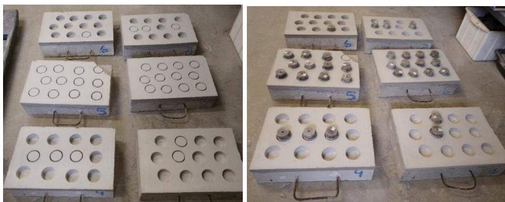
Figura 34 - (a) Corte dos testemunhos, (b) Fixação das pastilhas
