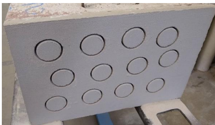
Figura 26 - Cortes no revestimento
