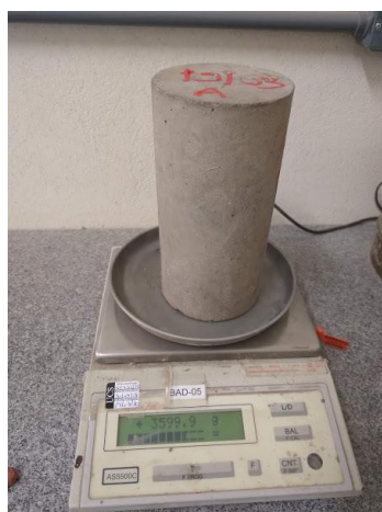
Figura 10 – Ensaio de absorção total do concreto
