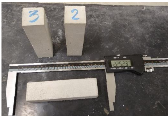
Figura 14 - Ensaio de densidade de massa no estado endurecido da argamassa
