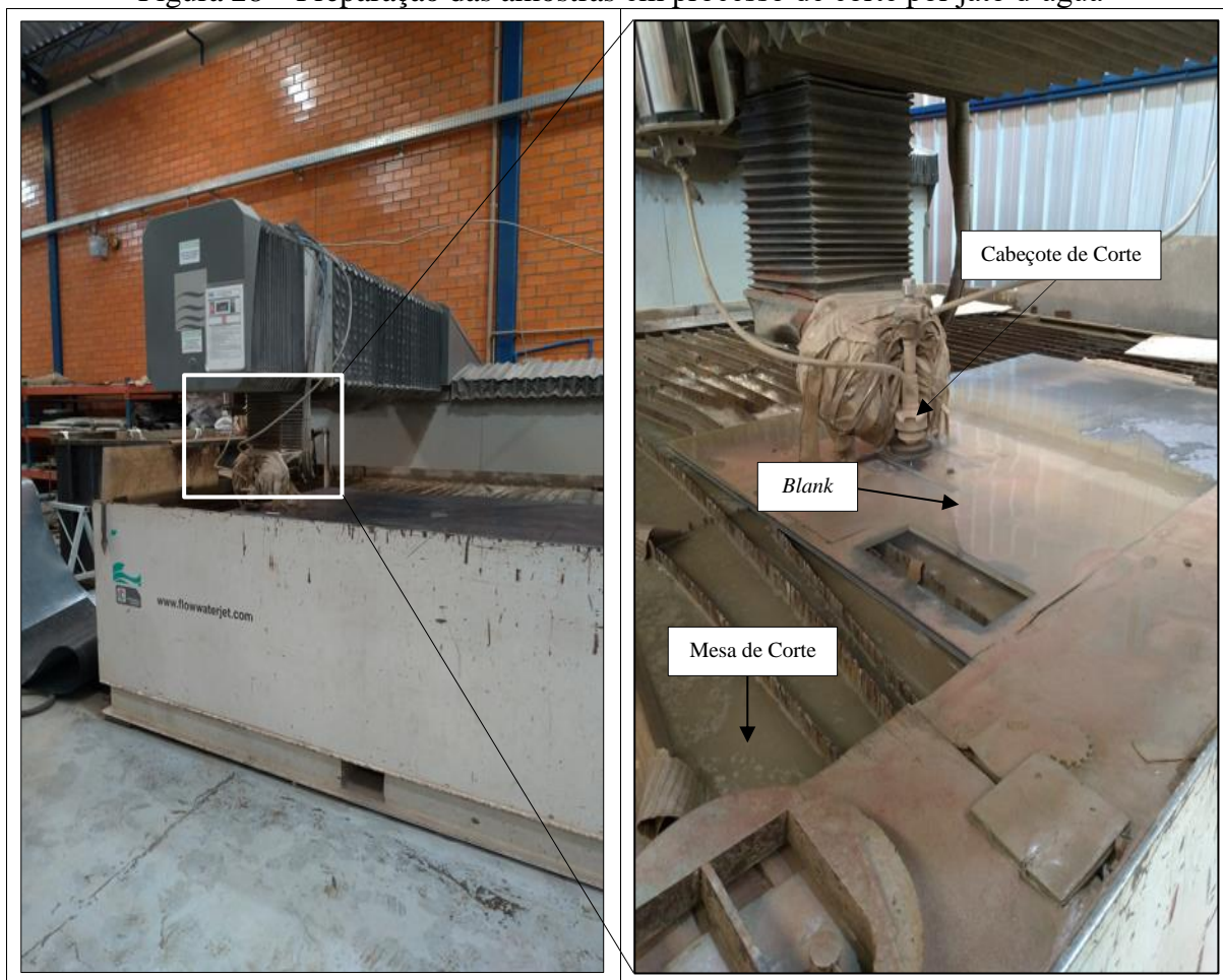
Figura 28 – Preparação das amostras em processo de corte por jato d'água
