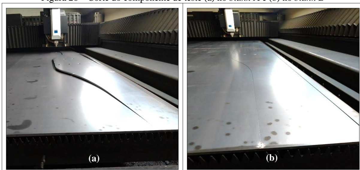
Figura 26 – Corte do componente de teste (a) no blank A e (b) no blank B
