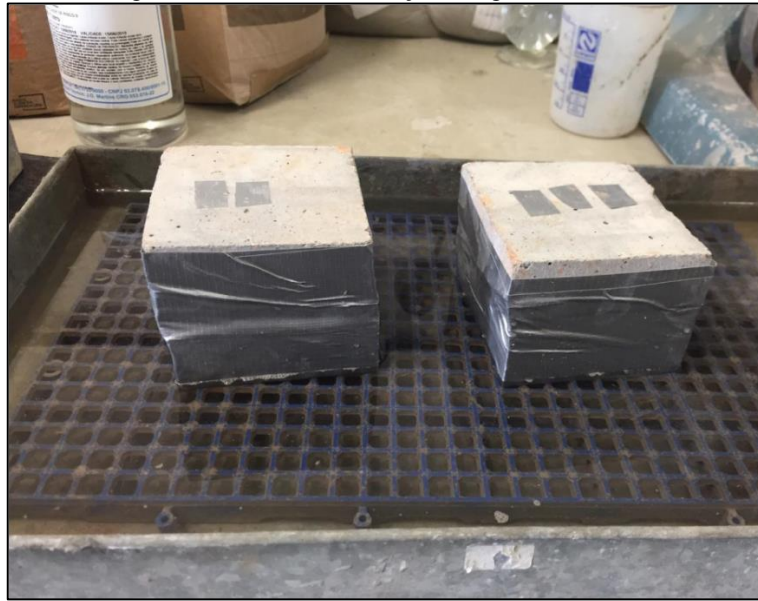
Figura 13 - Ensaio de absorção de água do substrato
