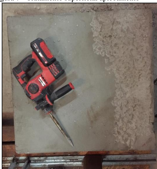
Figura 7 - Tratamento superficial apicoamento
