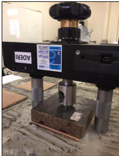
Figura 17 – Realização do ensaio de resistência de aderência
