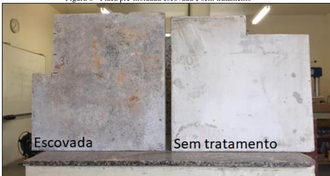
Figura 6 - Placa pré-moldada escovada e sem tratamento
