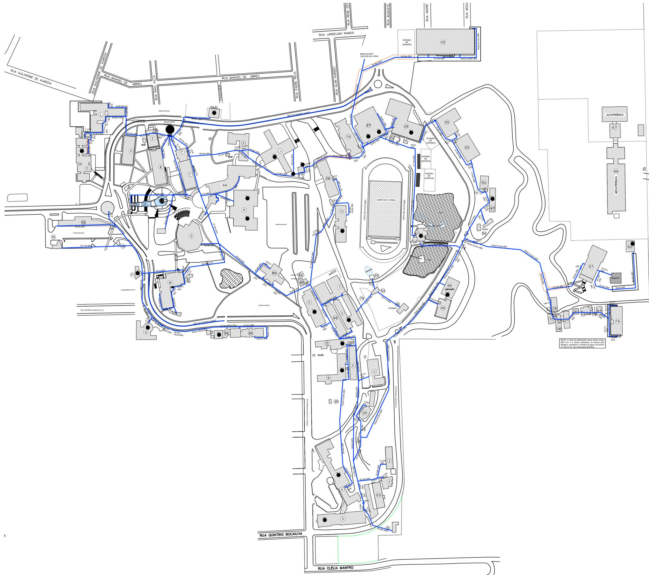
NOTA: Onde não indicado na planta, o material da rede é PVC-U com junta soldável. Quando a tubulação possuir material diferente, estará identificado.
