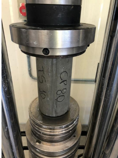
Figura 8 – Ensaio da resistência à compressão
