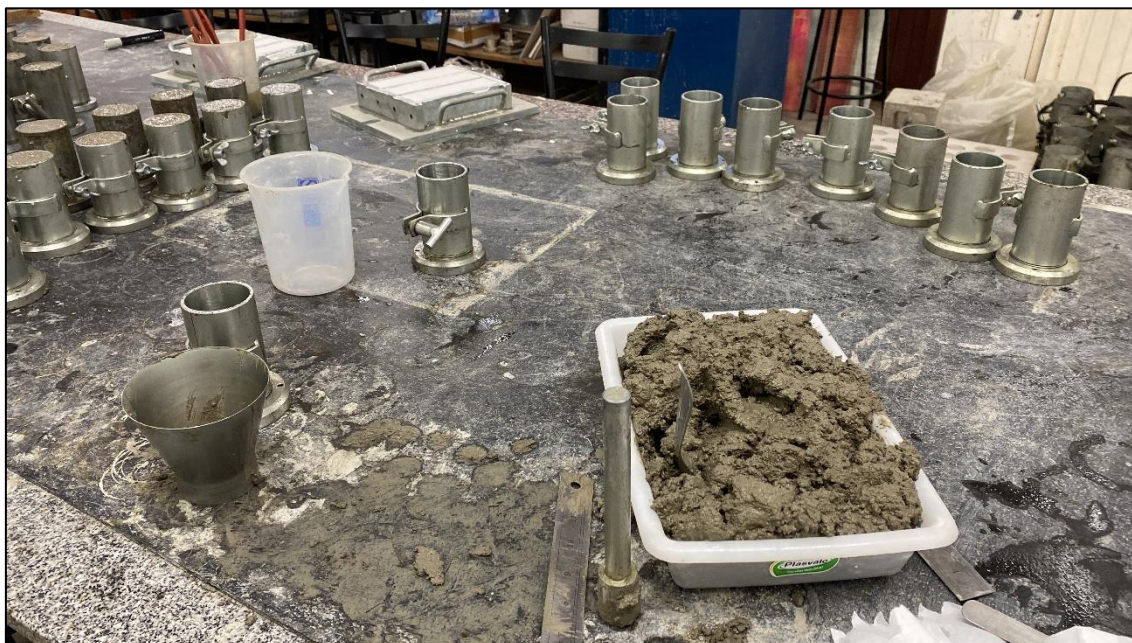
Figura 25 – Moldagem das amostras em forma cilíndricas.
