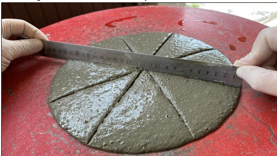
Figura 27 – Ensaio de determinação do índice de consistência.
