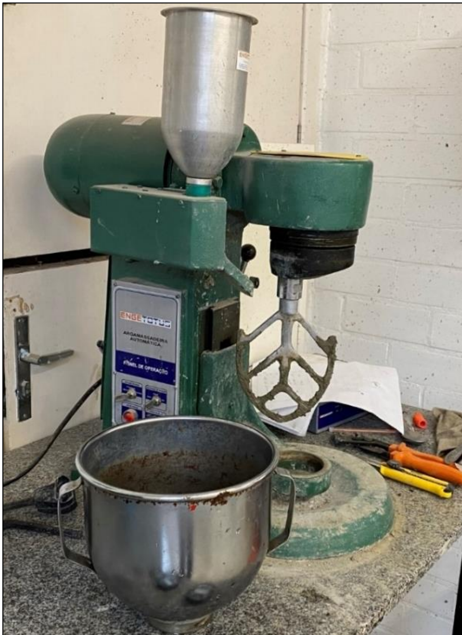
Figura 24 – Misturador mecânico utilizado.
