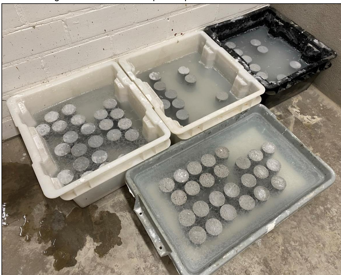
Figura 26 – Cura dos corpos de prova de forma submersa.
