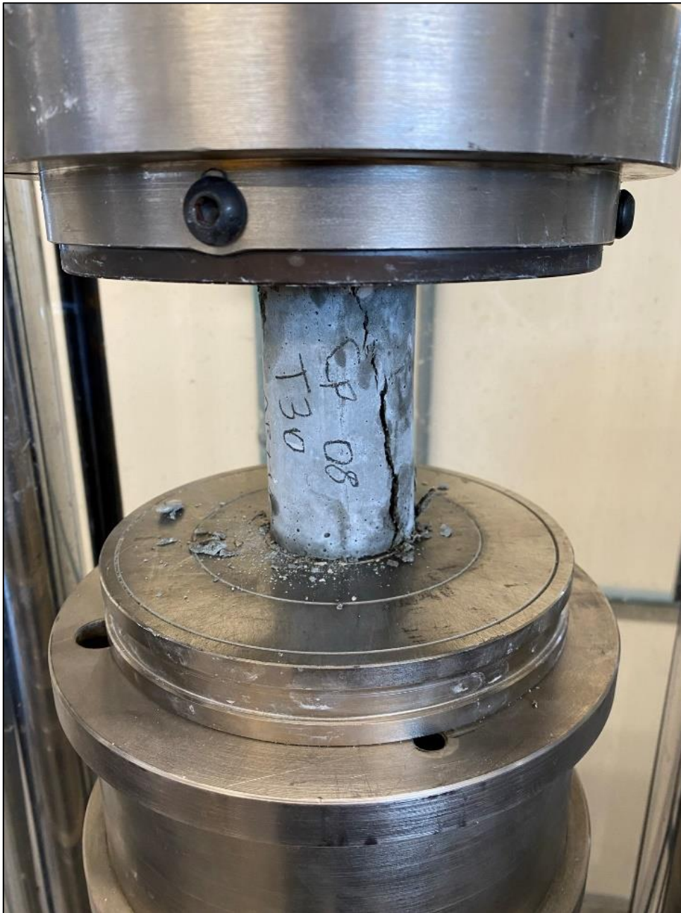
Figura 28 – Ensaio de resistência à compressão.
