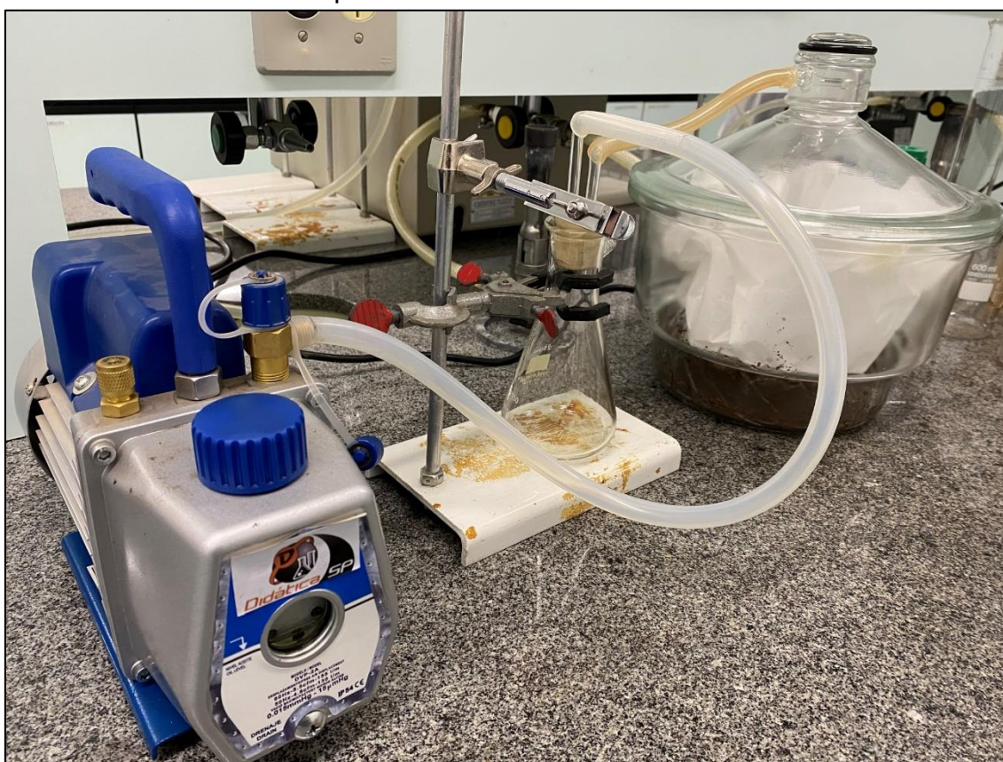
Figura 23 – Câmara de vácuo, acoplada em um dessecador de vidro, para encapsulamento do silicato de sódio.
