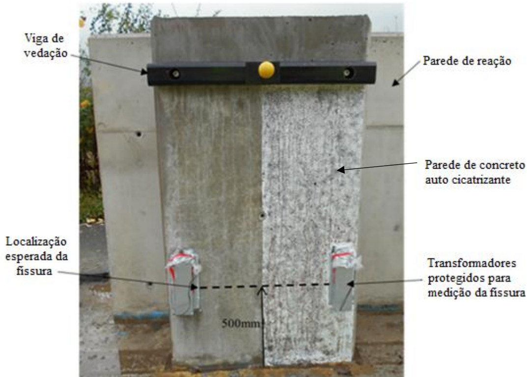
Figura 15 – Representação dos elementos do painel da parede e indicação da fissura de 500mm de largura que será formada.
