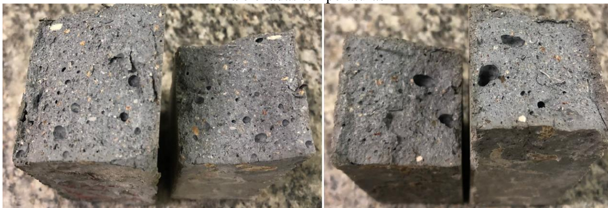
Figura 30 – Amostras de CUAD FA + 1,0% FP rompidos à tração na flexão após a exposição a elevadas temperaturas
