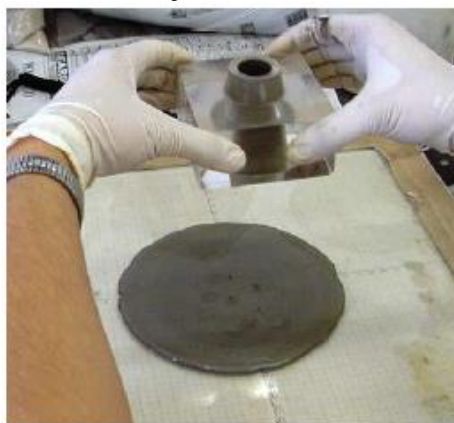
Figura 06 – Demonstração do ensaio de mini abatimento
