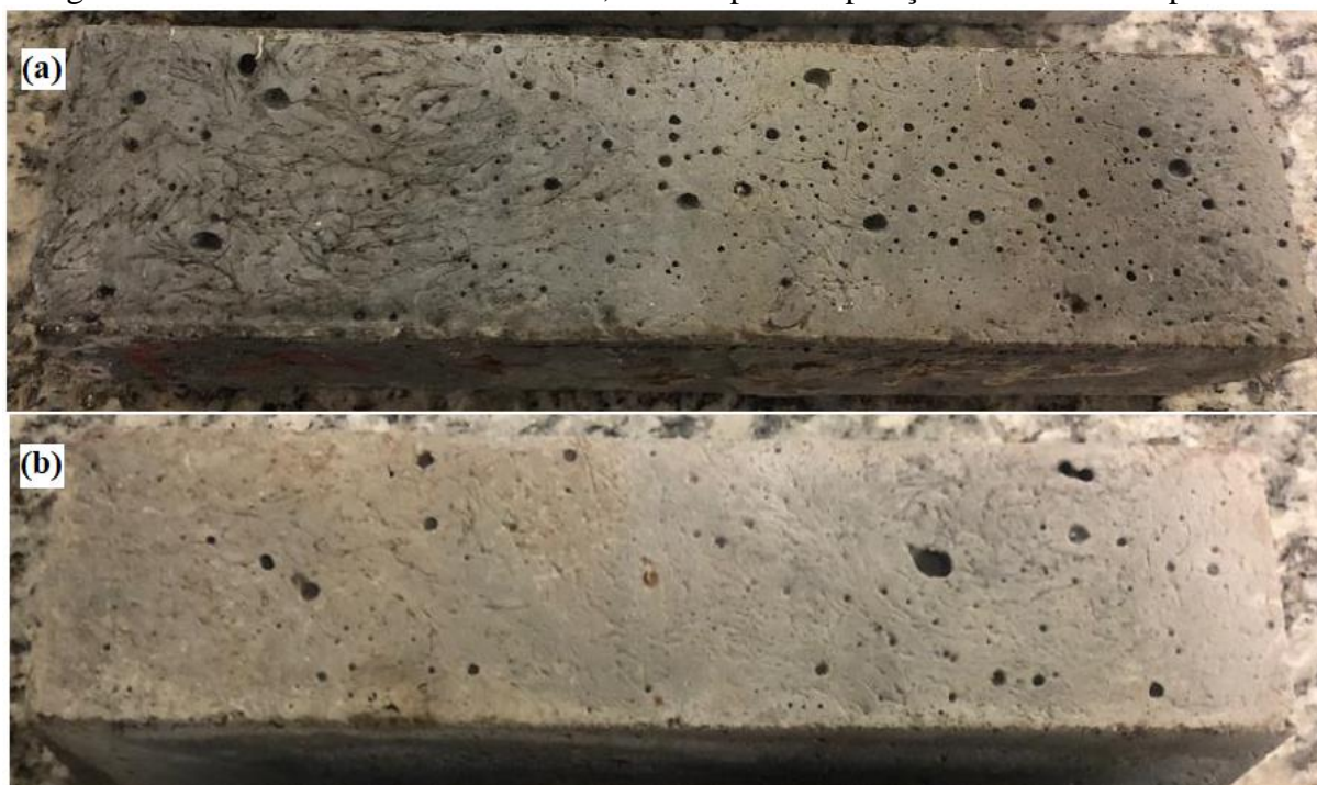
Figura 29 – Amostras de CUAD FA + 1,0% FP após a exposição à elevadas temperaturas
