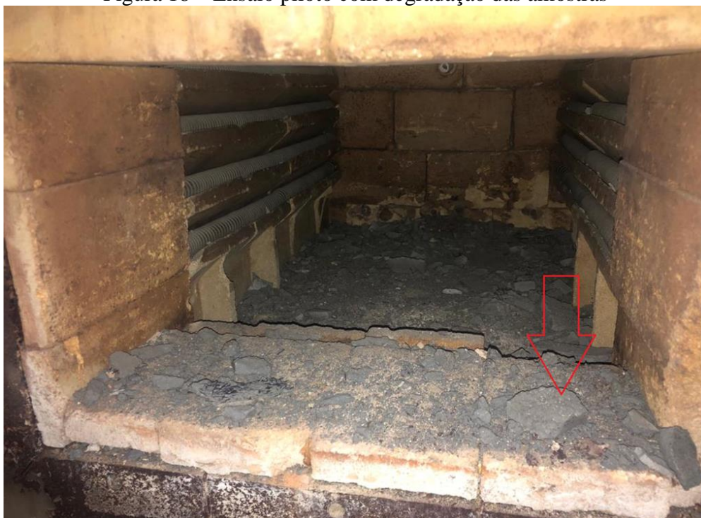
Figura 18 – Ensaio piloto com degradação das amostras
