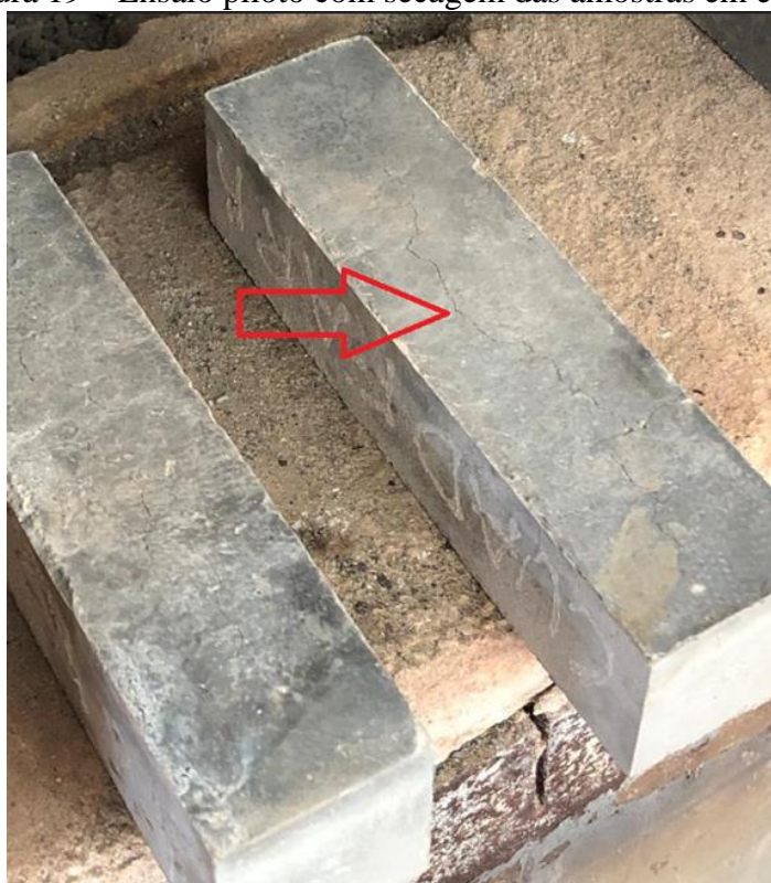
Figura 19 – Ensaio piloto com secagem das amostras em estufa
