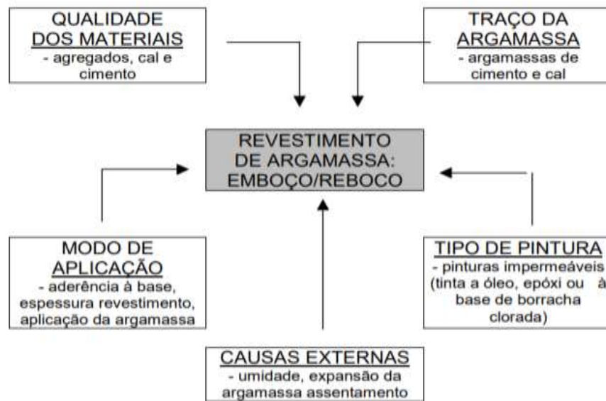
Figura 5 Causas das manifestações patológicas nos revestimentos de argamassa
