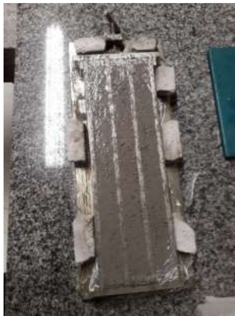
Figura 17 Vedação para evitar perda de umidade nas primeiras 48 horas.
