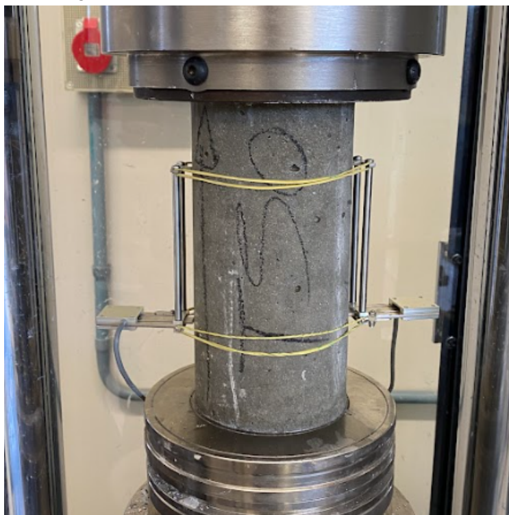
Figura 22: Ensaio do módulo de elasticidade.
