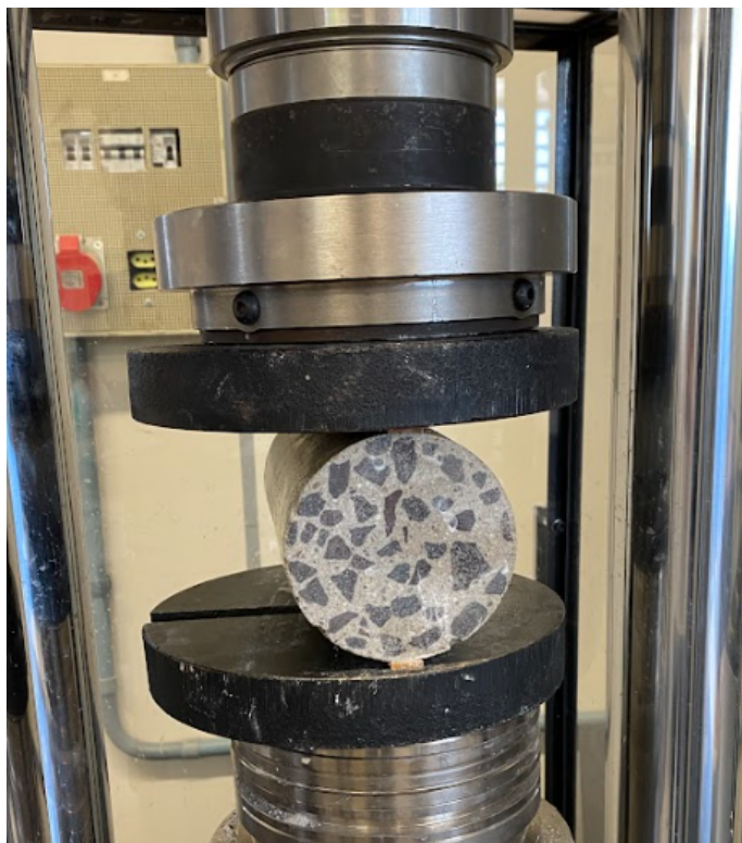
Figura 21: Ensaio de compressão diametral.
