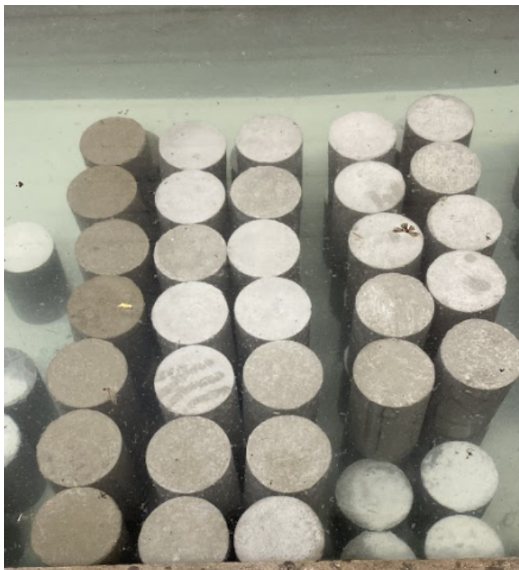
Figura 19: Corpos de prova em cura úmida
