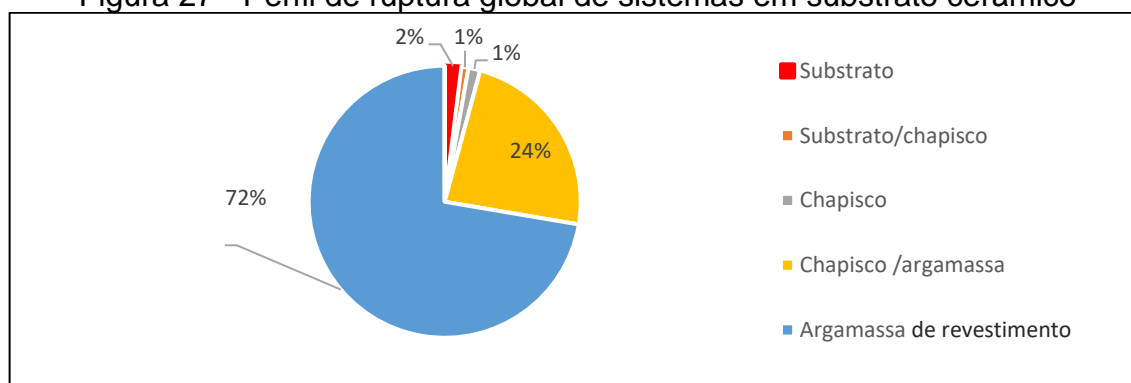
Figura 27 - Perfil de ruptura global de sistemas em substrato cerâmico
