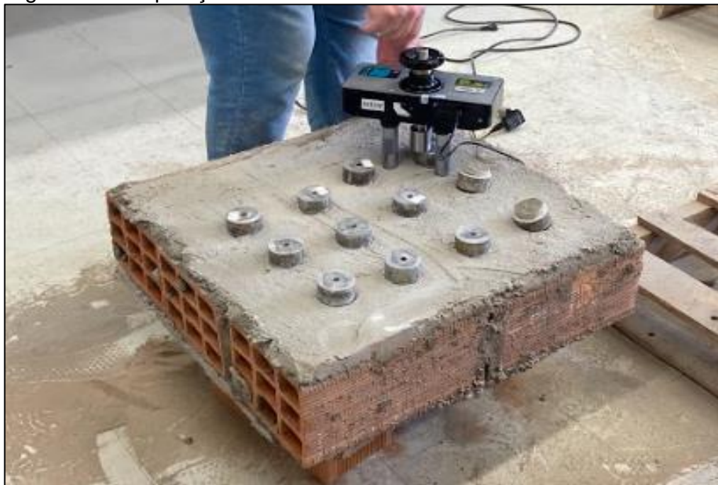
Figura 21 - Disposição dos testemunhos no momento do arrancamento
