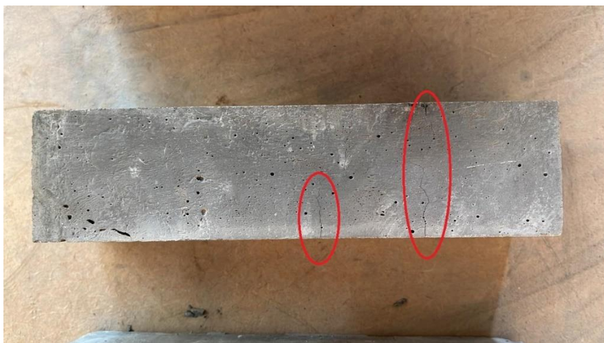
Figura 19 - Fissuras no corpo de prova
