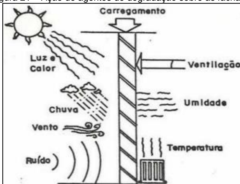
Figura 21 – Ação de agentes de degradação sobre as fachadas
