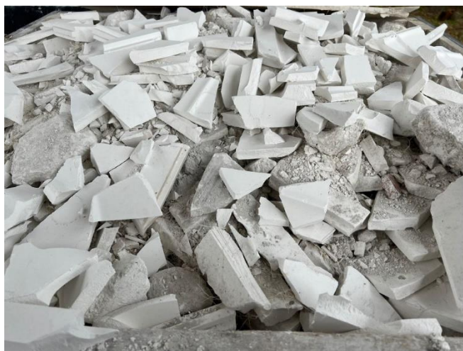
Figura 14 - Resíduo Gesso Convencional, gerado em obra
