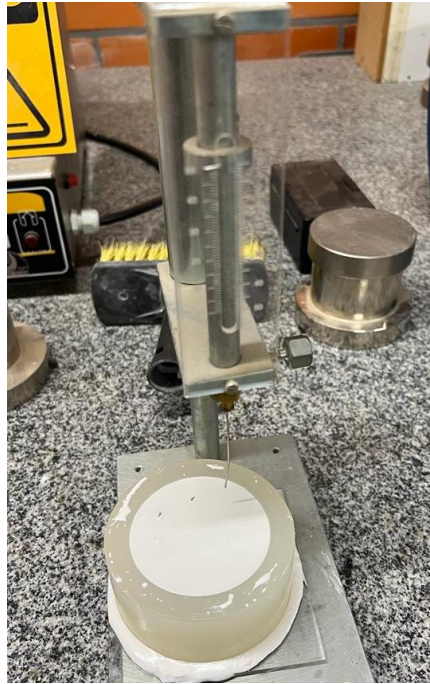
Figura 36 - Molde e Vicat modificado para início do ensaio
