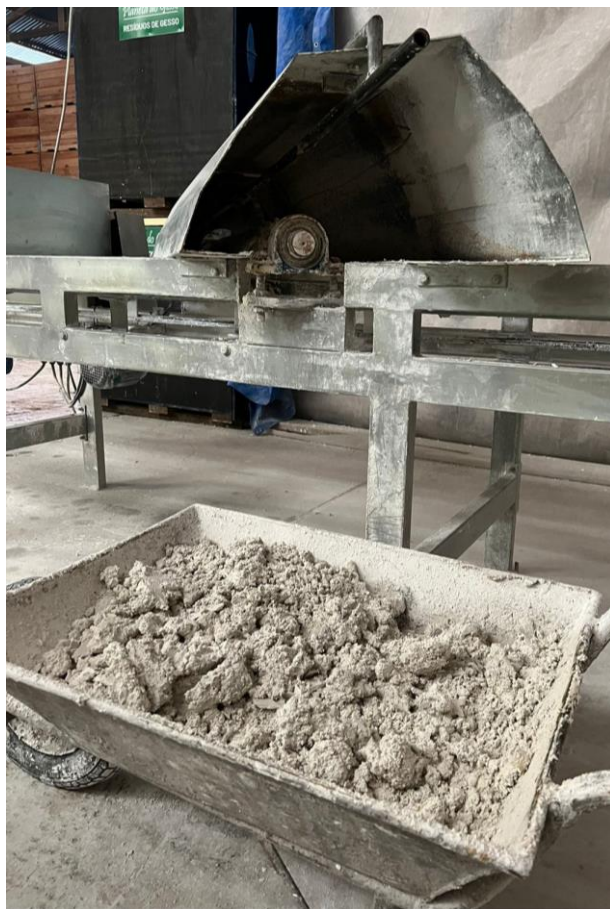
Figura 20 - Resíduo Fabricação de Placas de Gesso
