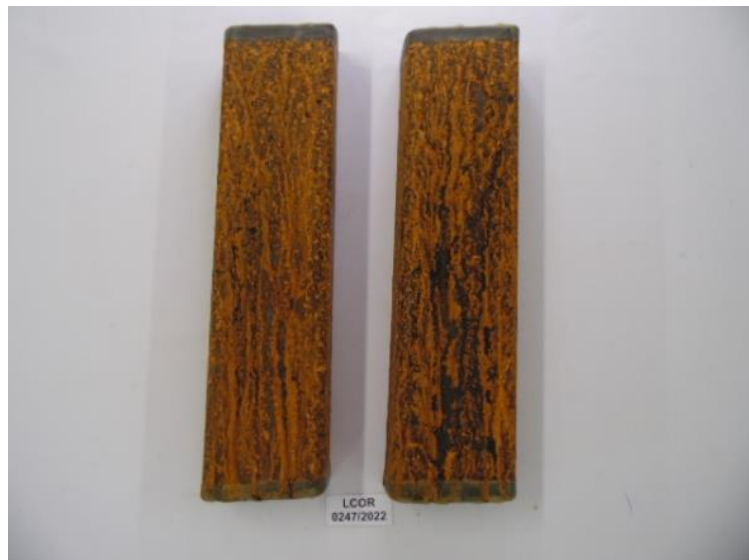
Figura 36 - Peças V1 com 24 horas de exposição
