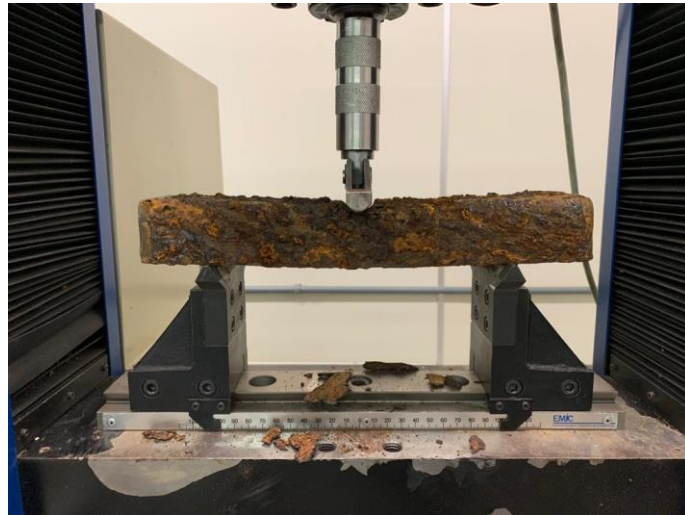
Figura 74 - V3A posicionada nos apoios
