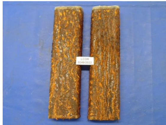
Figura 68 - Peças V3 com 336 horas de exposição
