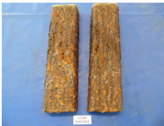
Figura 70 - Peças V3 com 1008 horas de exposição
