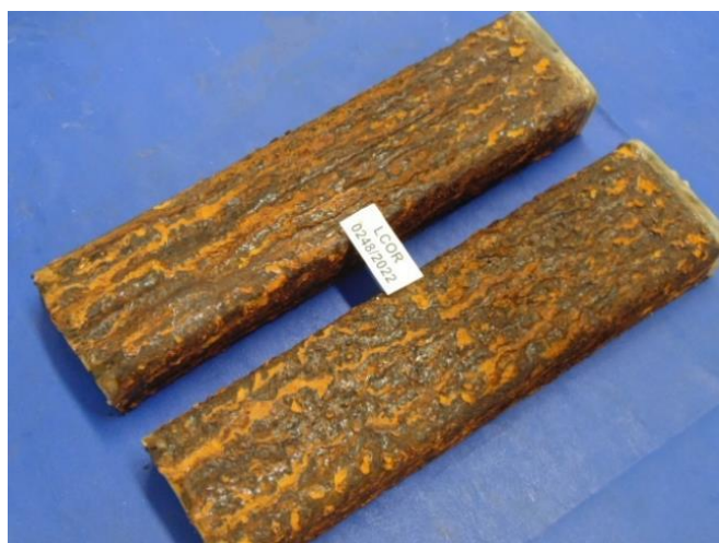
Figura 54 - Peças V2 com 336 horas de exposição
