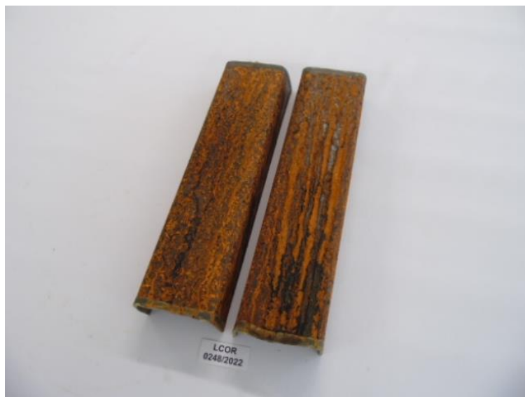
Figura 52 - Peças V2 com 24 horas de exposição
