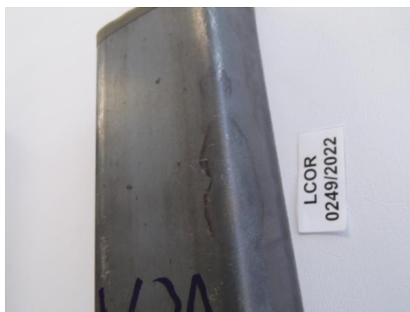
Figura 64 - Imperfeições e manchas V3A e V3B
