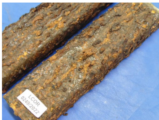
Figura 72 - Peças V3 com 1512 horas de exposição
