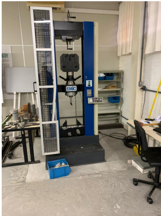
Figura 25 - Prensa hidráulica de 200 kN, modelo Emic DL2000
