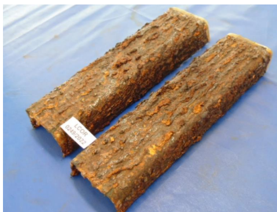
Figura 71 - Peças V3 com 1344 horas de exposição
