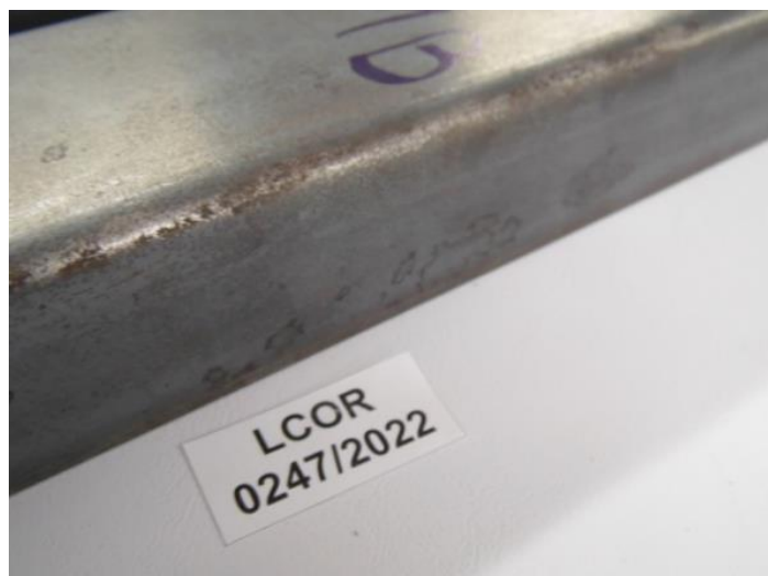
Figura 35 – Imperfeições e manchas V1A e V1B
