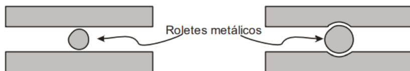
Figura 14 – Esquema dos apoios de primeira e segundo gênero respectivamente
