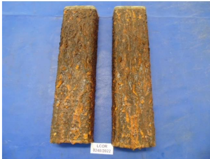
Figura 55 - Peças V2 com 504 horas de exposição
