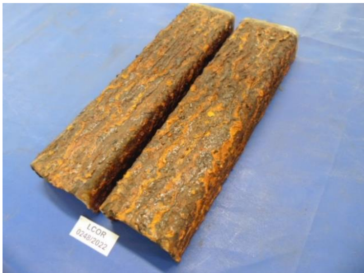
Figura 56 - Peças V2 com 672 horas de exposição
