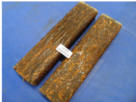
Figura 69 - Peças V3 com 504 horas de exposição
