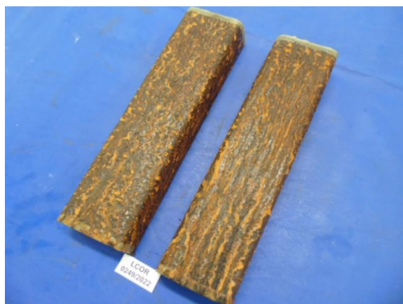
Figura 67 – Peças V3 com 168 horas de exposição
