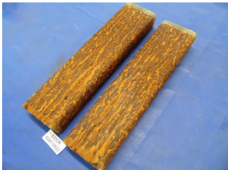
Figura 41 - Peças V1 com 168 horas de exposição
