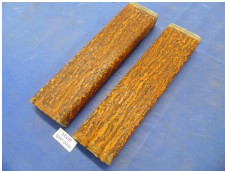
Figura 39 – Peças V1 com 72 horas de exposição
