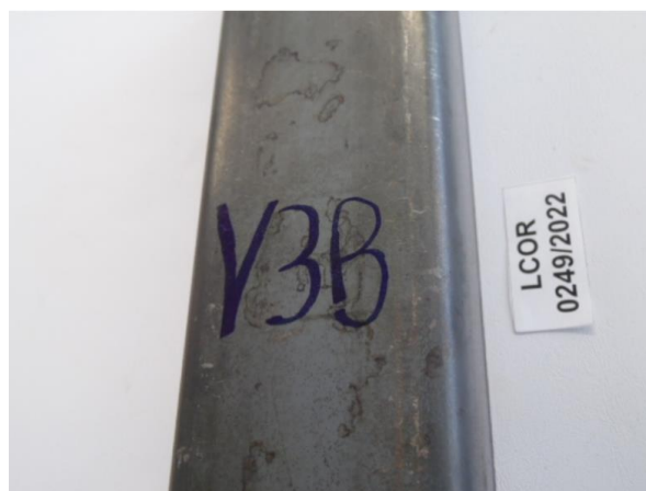
Figura 65 - Imperfeições e manchas V3A e V3B
