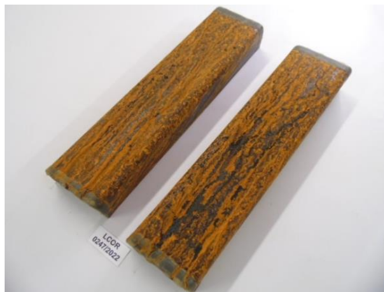
Figura 37 - Peças V1 com 24 horas de exposição
