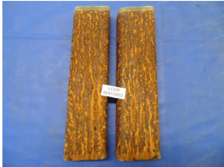
Figura 40 – Peças V1 com 168 horas de exposição
