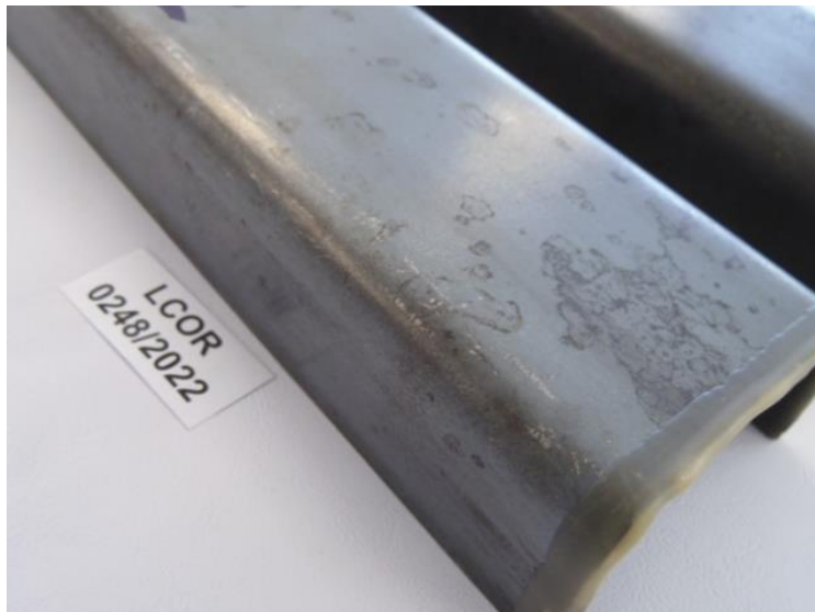
Figura 51 - Imperfeições e manchas V2A e V2B
