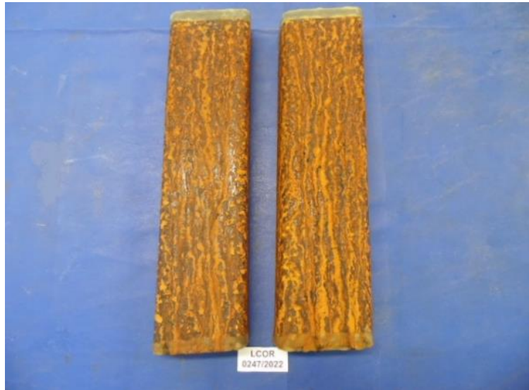
Figura 38 - Peças V1 com 72 horas de exposição
