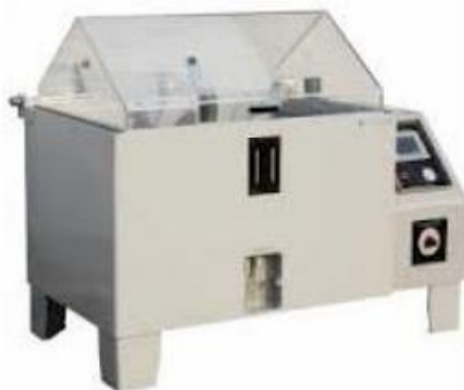
Figura 24 – Câmara de névoa salina modelo USX-6000/2012 utilizada no ensaio
