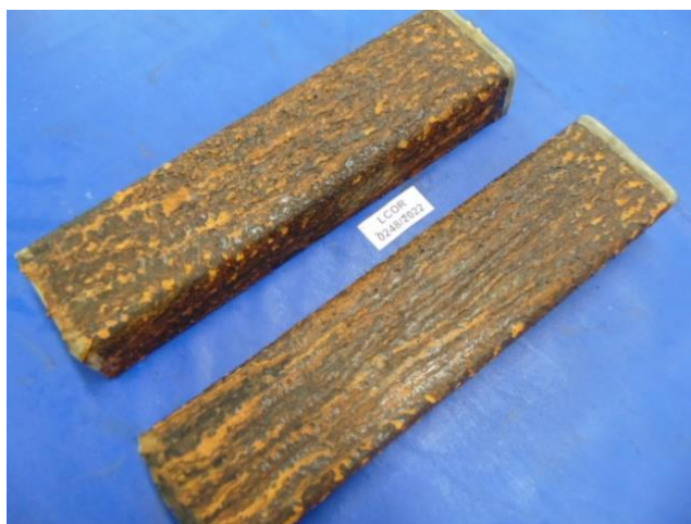
Figura 53 - Peças V2 com 168 horas de exposição
