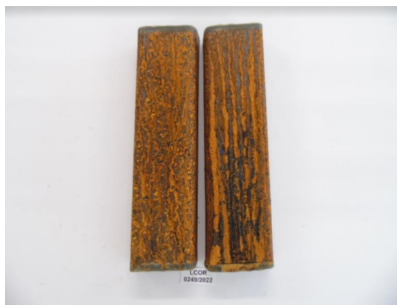
Figura 66 - Peças V3 com 24 horas de exposição
