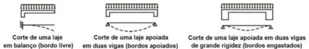
Figura 2-Deformações de acordo com os vínculos em bordos.
