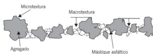
Figura 21 - Micro e macrotextura na superfície de um revestimento asfáltico
