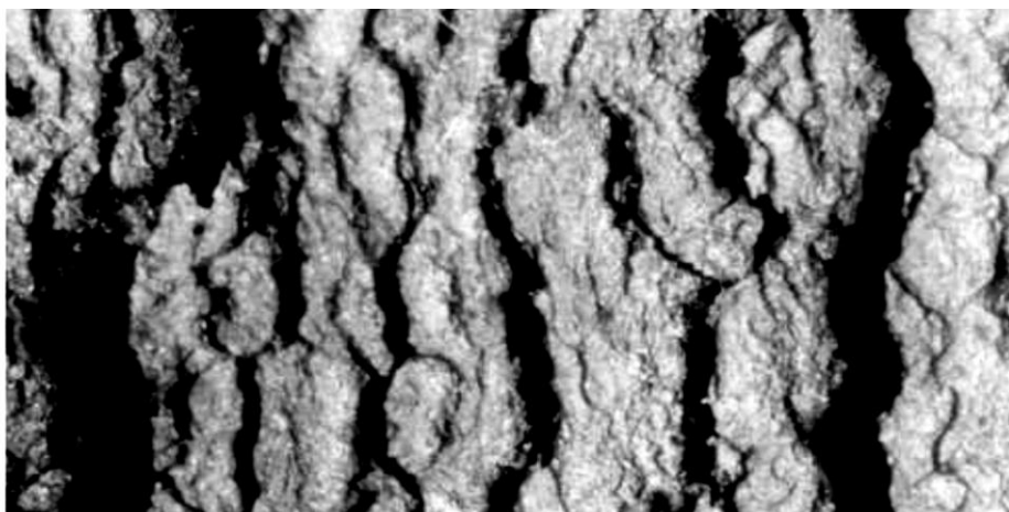
Figura 11 – Microscopia ótica da superfície de borracha natural com formação de trincas [106].
