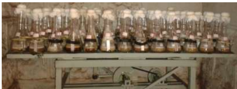
Figura 4 – Cultivo de Aspergillus niger LB-02-SF em frascos sob agitação em agitador recíproco construído na UCS.
