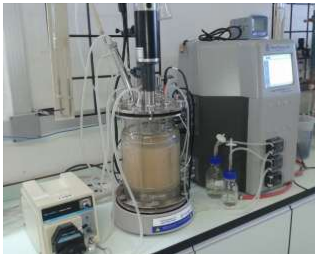
Figura 5 - Cultivo de Aspergillus niger LB-02-SF em biorreator de bancada (BioFlo/CelliGen 115, New Brunswick/EUA).
