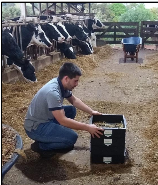
Figura 10 - Avaliação de tamanho de partículas de dieta total utilizando peneira separadora de partículas Penn State.
