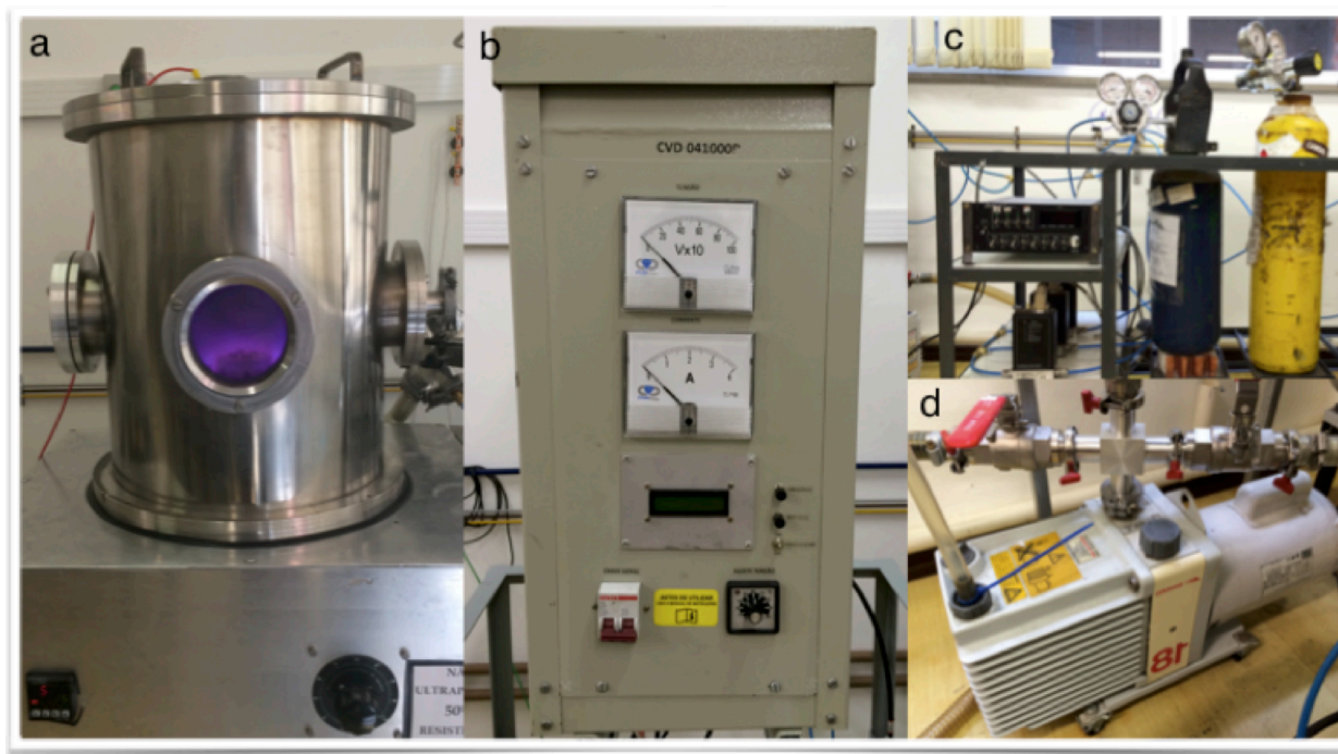
Figura 16 - (a) Câmara Nitretadora; (b) Fonte CVD 041000P; (c) Controlador de Fluxo de gases; (d) Bomba de Vácuo.
