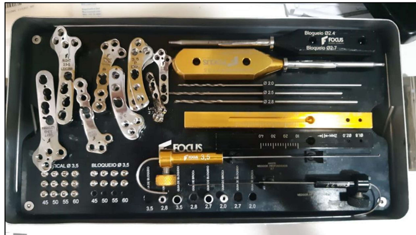
Figura 12 - Caixa cirúrgica com material para TPLO + Sistema Focus de placas bloqueadas 3.5 mm utilizados na Osteo & Síntese Veterinária
