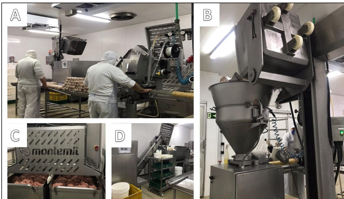
Figura 3 - Agroindústria de produção de embutidos: confecção do salame (A), transporte da matéria prima (B), matéria prima temperada (C), matéria prima triturada (D).
