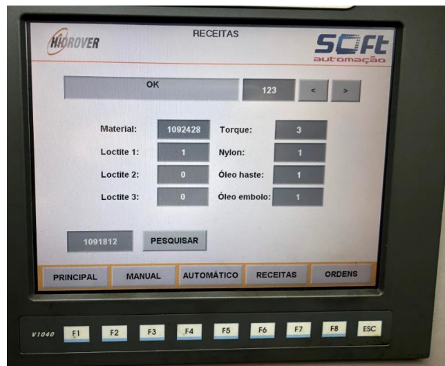
Figura 32- Receita para montagem.
