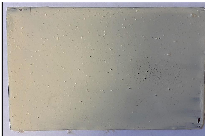
Figura 15 - Amostra aço SAE 1006 após 1ª camada de revestimento geopolímero curado
