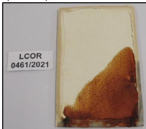
Figura 39 - Amostra de aço SAE 1006 com duas camadas de revestimento geopolímero após 240 horas em névoa salina
