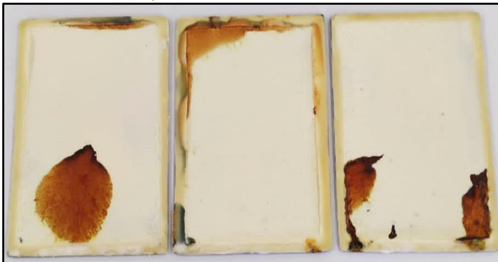
Figura 33 - Amostra aço SAE 1006 com uma camada de revestimento geopolímero após 48 horas em névoa salina
