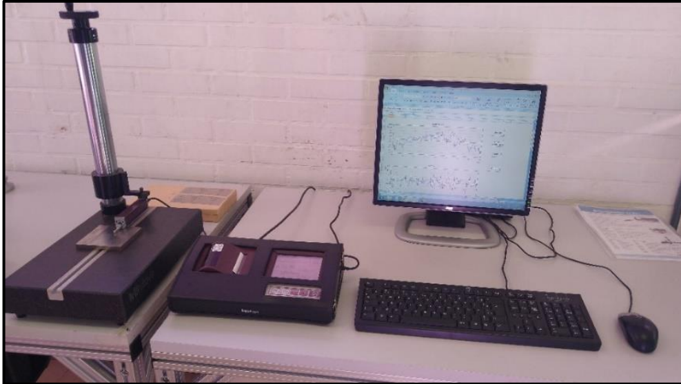
Figura 23 - Bancada da realização do ensaio com o equipamento SurfTest SJ-301
