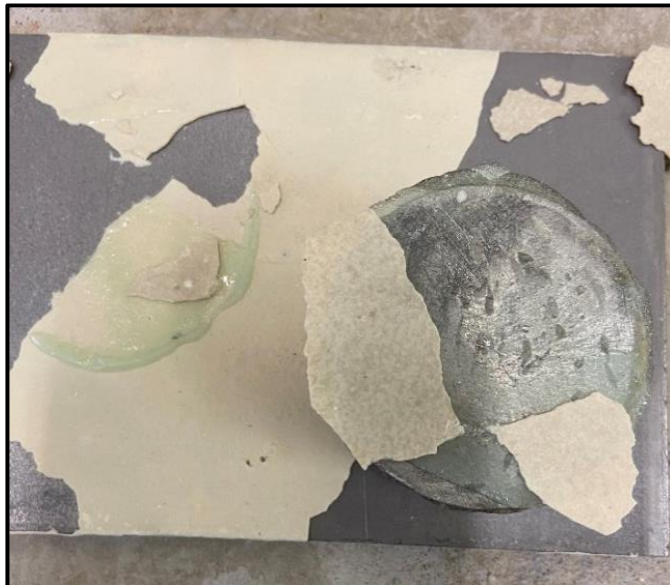
Figura 45 - Amostra em aço SAE 1020 com deslocamento do revestimento geopolímero após o ensaio de pull off
