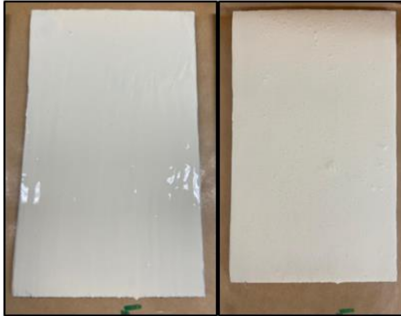
Figura 16 - Amostra 5 aço SAE 1020 com 2ª camada antes e depois da cura
