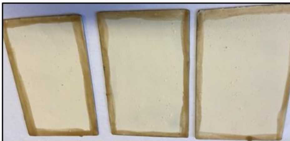
Figura 20 - Amostras preparadas para o ensaio de imersão em solução neutra
