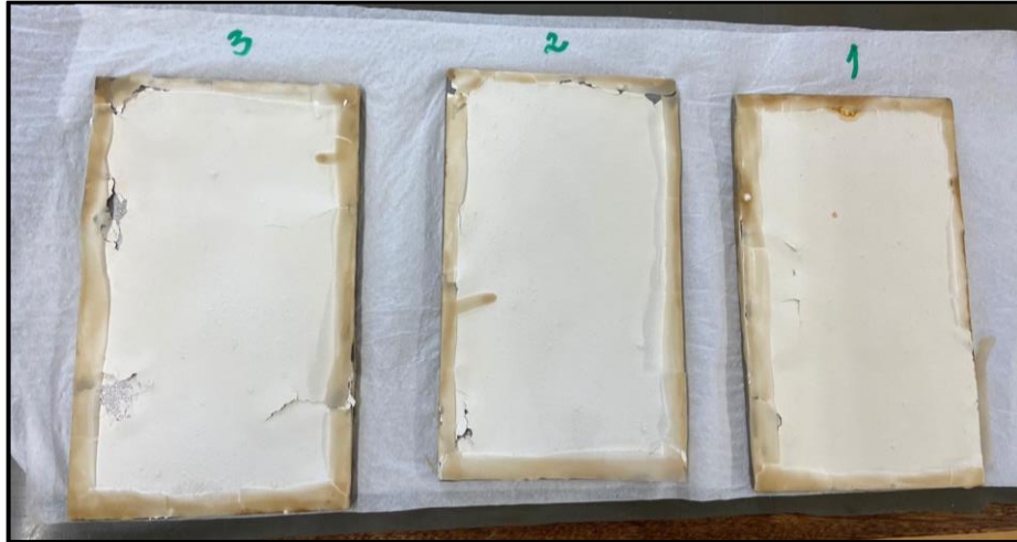
Figura 43 - Amostras de aço SAE 1020 com 1 camada de revestimento geopolímero após imersão de 96 horas e posterior secagem sob a bancada por 72 horas
