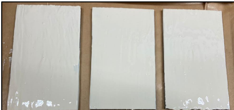
Figura 13 - Amostras com a aplicação de revestimento geopolimérico
