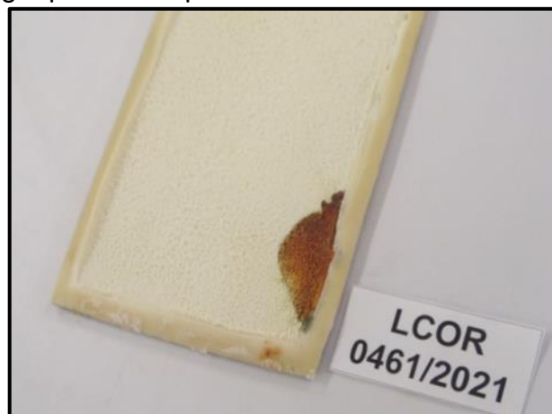
Figura 37 - Amostra de aço SAE 1006 com duas camadas de revestimento geopolímero após 48 horas em névoa salina
