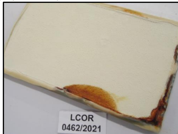
Figura 38 - Amostras de aço SAE 1020 com duas camadas de revestimento geopolímero após 168 horas em névoa salina
