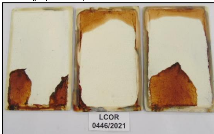
Figura 35 - Amostras de aço SAE 1006 com uma camada de revestimento geopolímero após 96 horas em névoa salina
