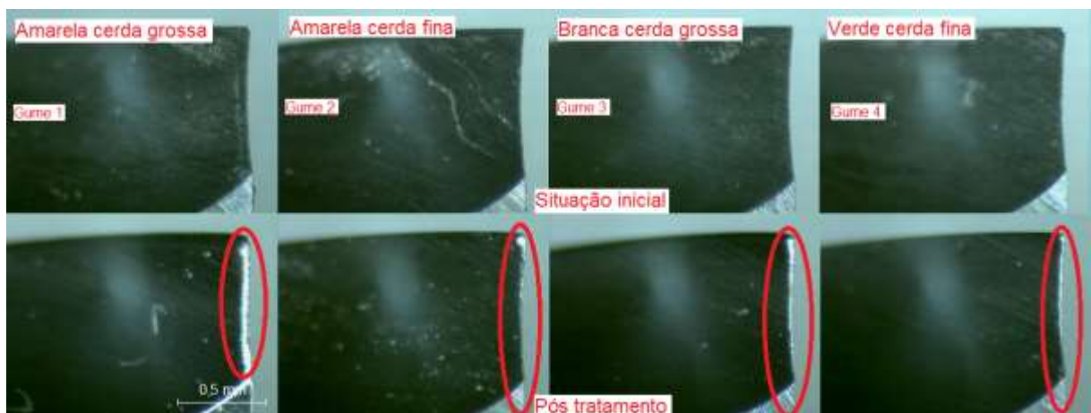
Figura 16 – Análise da face dos gumes antes e depois do tratamento
