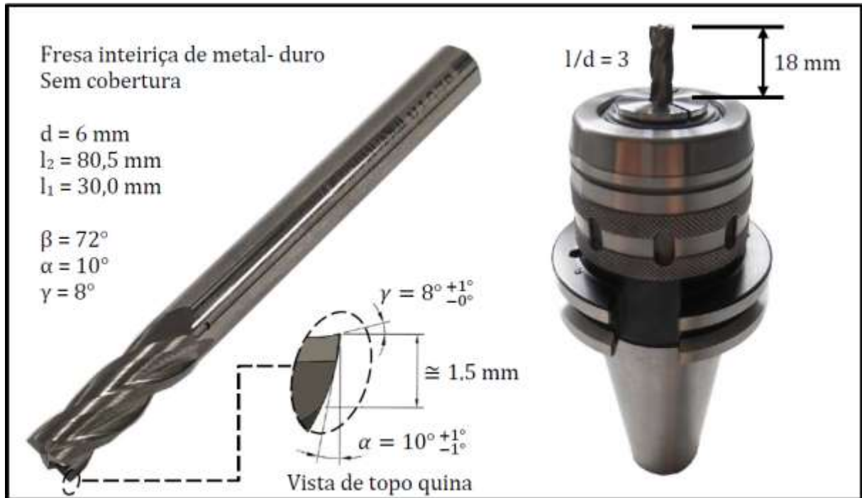
Figura 12 – Especificações da ferramenta
