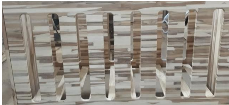
Figura 62 - Laterais usinadas e seus espaçamentos
