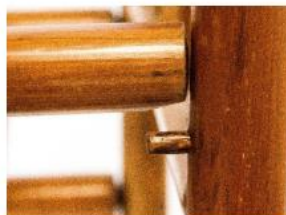
Figura 18 - Berço Patente: detalhe do encaixe da parte inferior da grade lateral (supostamente alterado)
