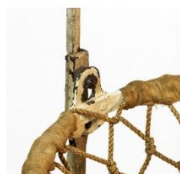
Figura 3 - Detalhe do pino de sustentação do cesto
