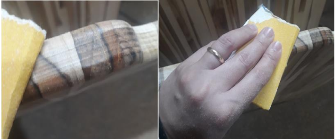
Figura 65 –Processo lixamento das peças manual
