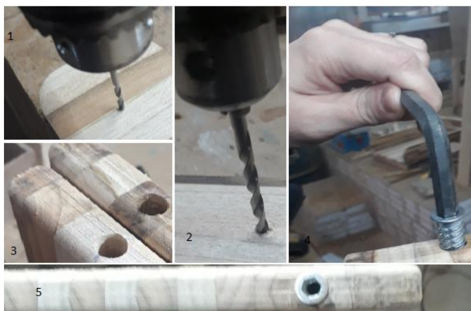
Figura 70 – Fixação da Bucha Americana nas laterais do berço
