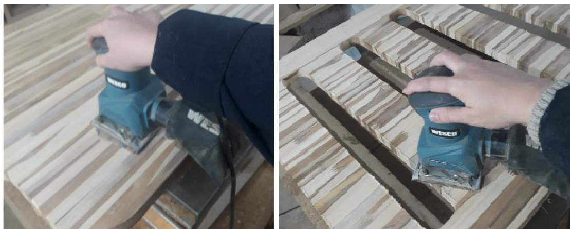
Figura 64 – Processo lixamento das com peças treme-treme
