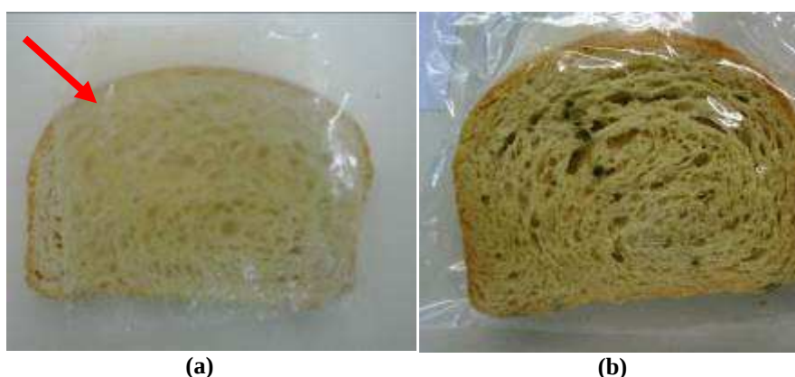
Figura 13 – (a) Amostras de pão tipo forma em contato com filme desenvolvido, (b) Conjunto de duas fatias de pão tipo forma em contato com filme e embalado em embalagem de PP.
