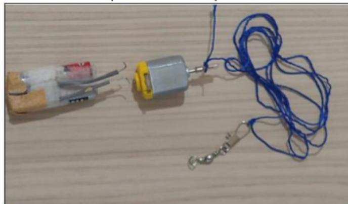
Neste experimento, a frequência de rotação do motor gera ondas estacionárias no barbante a partir da superposição das ondas refletidas nas extremidades fixas do barbante.
