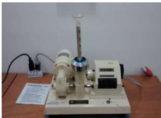
Figura 26– Equipamento (volumétrico de compactação) utilizado na determinação das características de empacotamento das matérias-primas e das formulações argila-rocha. Faculdade de Farmácia-UFRGS.
