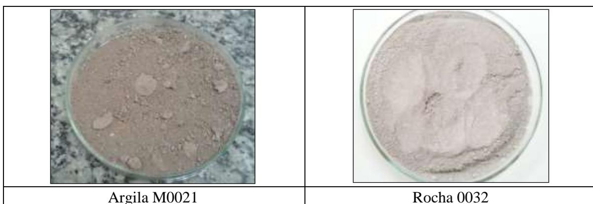
Figura 27 – Matérias primas após desintegração e homogeneização.
