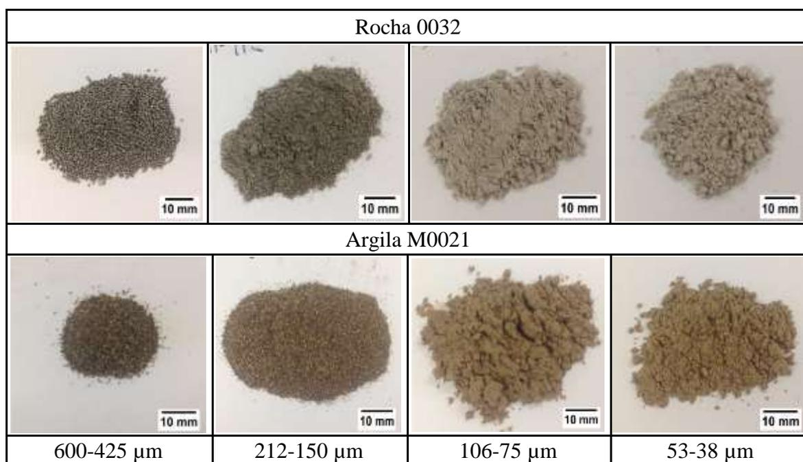
Figura 41– Imagens das matérias-primas em diferentes faixas de tamanhos separadas por peneiramento úmido (estereoscópio Olympus SZ61).
