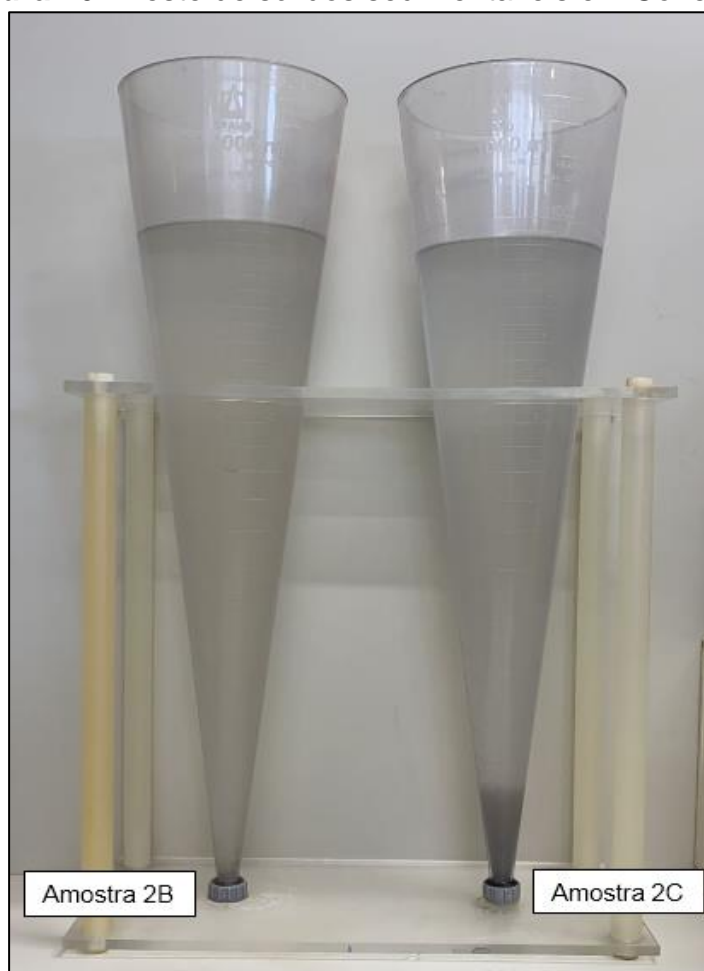
Figura 16 - Teste de sólidos sedimentáveis em Cone Imhoff
