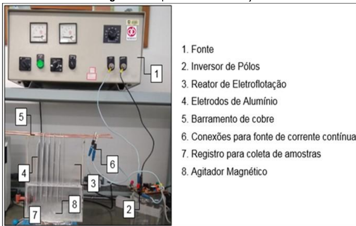
Figura 9 - Esquema de Eletroflotação
