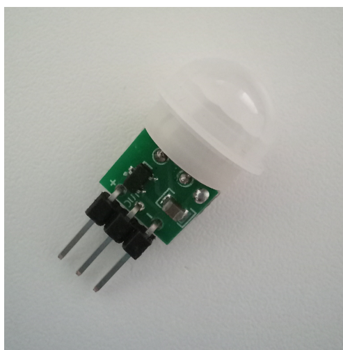
Figura 11 – Sensor de movimento PIR
