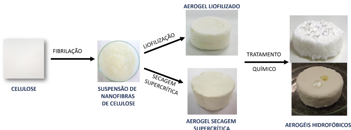
Figura 8. Fluxograma de obtenção dos aerogéis.
