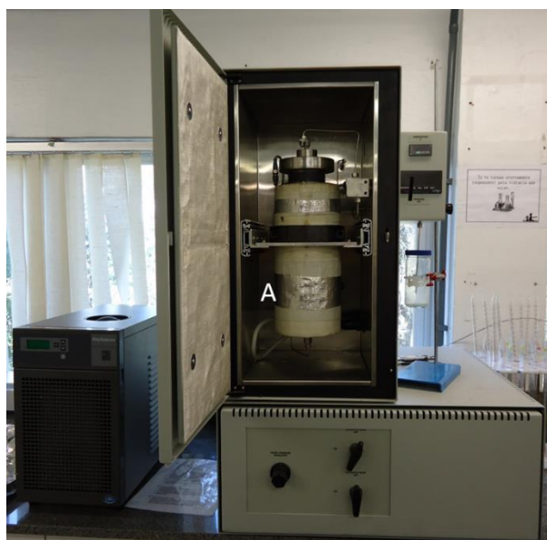
Figura 11. Fotografia do equipamento utilizado na secagem supercrítica, com visualização do vaso de pressão (A).
