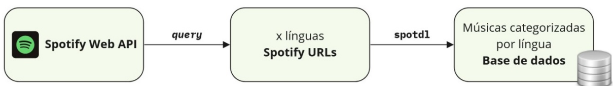
Figura 30 – Diagrama do modelo de construção da base de dados.
